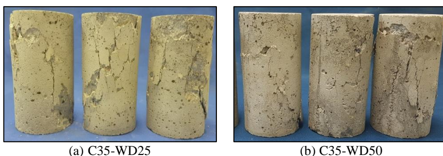
Figura 5.27 – Amostra do tipo de ruptura dos concretos da C35 no ensaio de resistência à compressão
