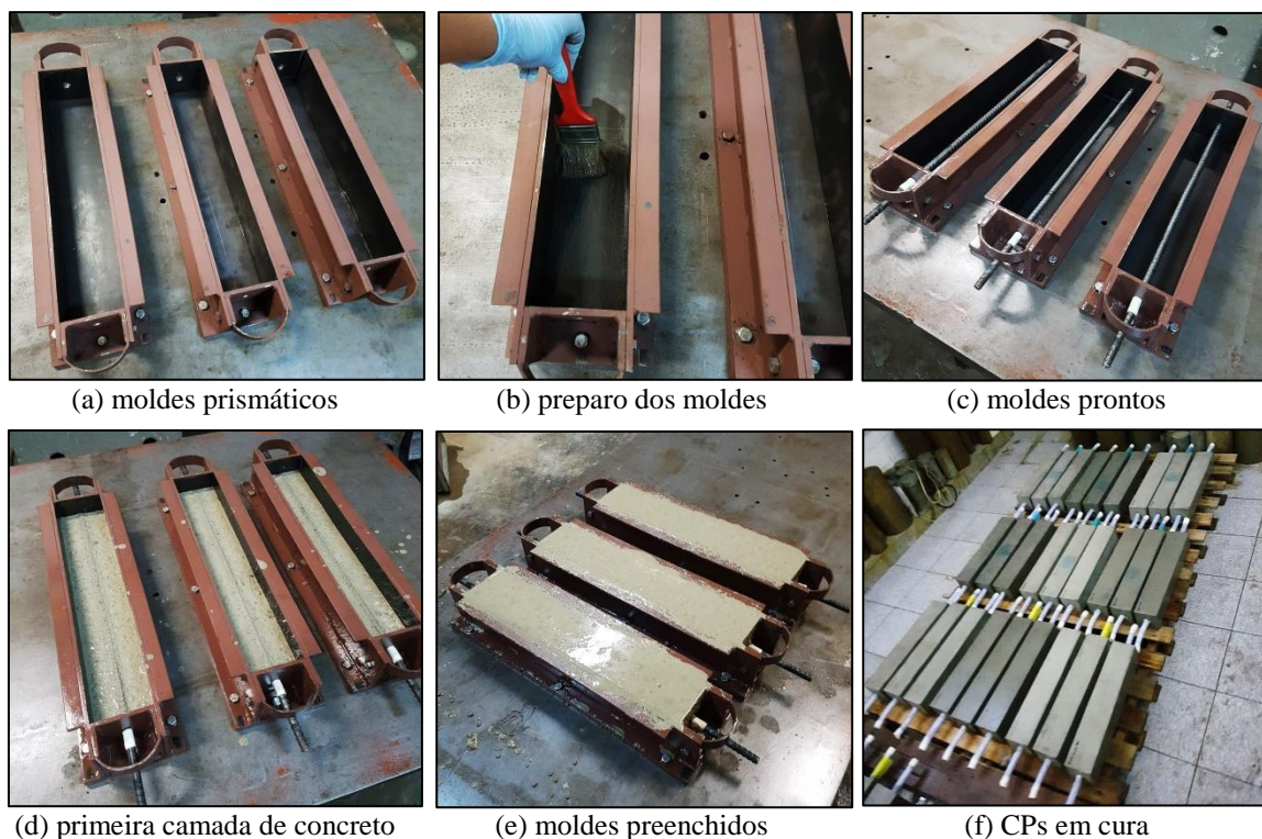
Figura 4.10 – Produção dos elementos estruturais
