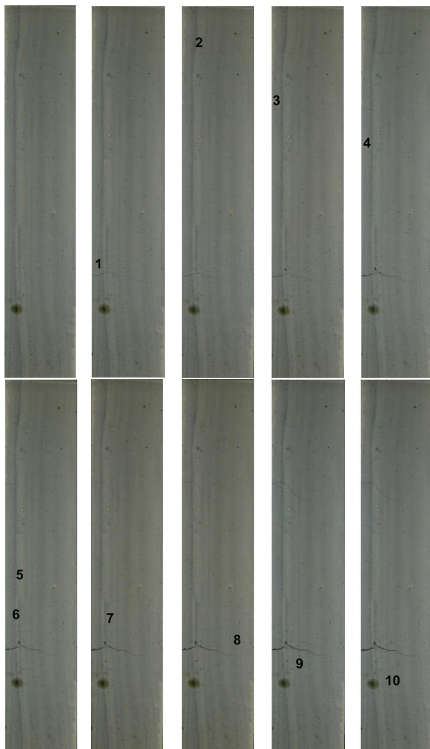
Figura 5.68 – Amostra do processo de fissuração no corpo de prova de tirantes com matrizes com fibras (1%) sob esforços de tração, com marcação da ordem das fissuras
