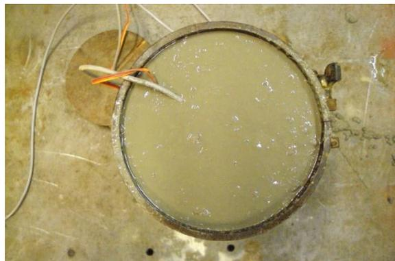
(b) Enchimento dos corpos de prova
