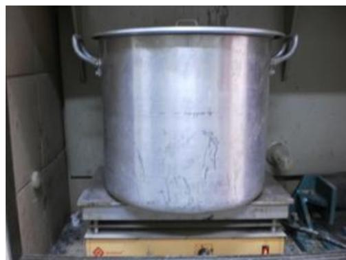
(b) Fervura dos corpos de prova
