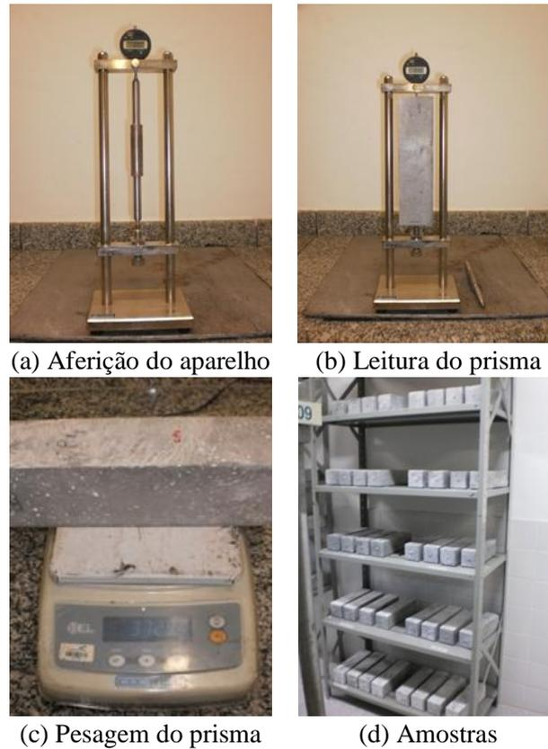
Figura 4.33 – Ensaio de retração por secagem.
