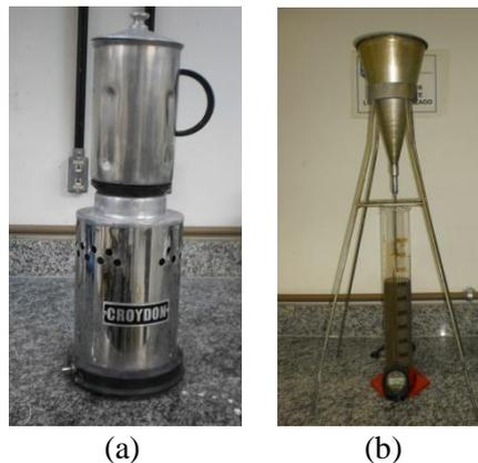
Figura 3.38 – Equipamentos para a determinação da compatibilidade entre do cimento e superplastificante e do ponto de saturação:(a) misturador, (b) funil de Marsh e proveta graduada e cronometro.
