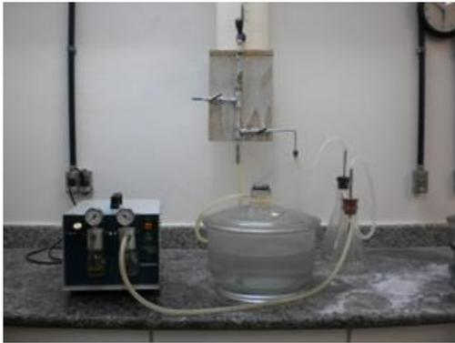
(a) Saturação dos corpos de prova
