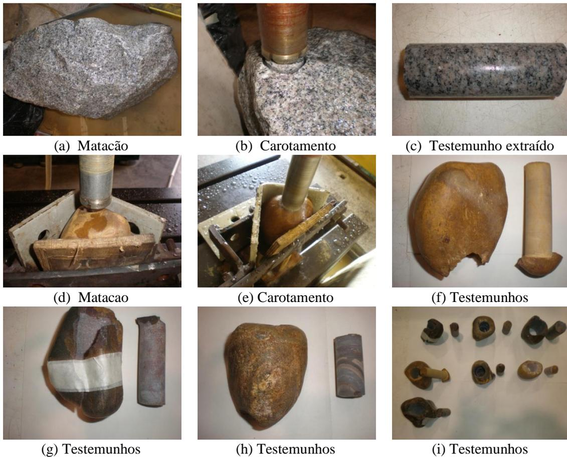
Figura 3.11 – Amostras de agregado graúdo para ensaio do módulo de elasticidade.
