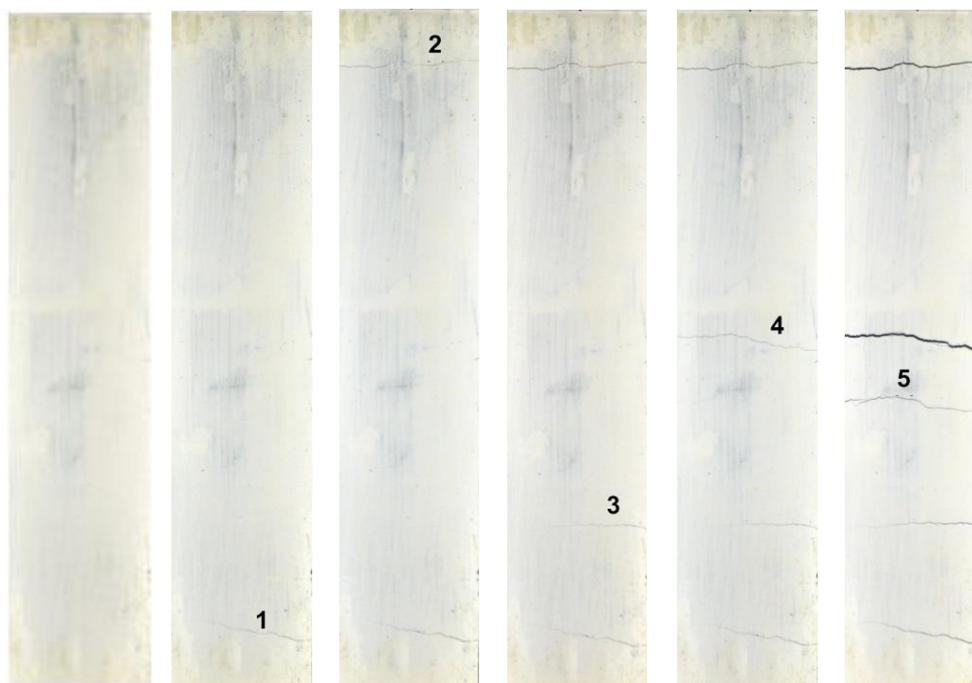
Figura 5.61 – Amostra do processo de fissuração no corpo de prova de tirantes com matriz de referência sob esforços de tração, com marcação da ordem das fissuras
