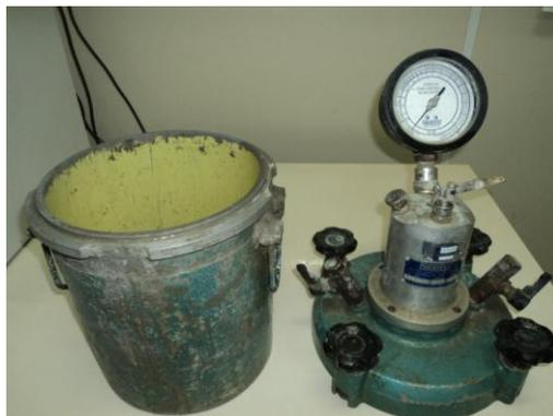
Figura 4.13 – Pressômetro
