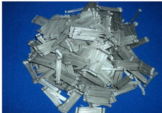
Figura 3.41 – Fibras de aço Dramix RC 65/35 BN
