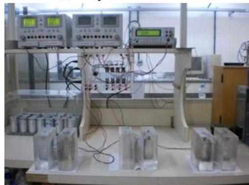
(f) Ligação dos eletrodos ao capacitor
