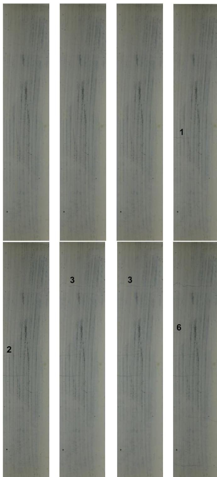
Figura 5.66 – Amostra do processo de fissuração no corpo de prova de tirantes com matrizes com fibras (0,5%) sob esforços de tração, com marcação da ordem das fissuras
