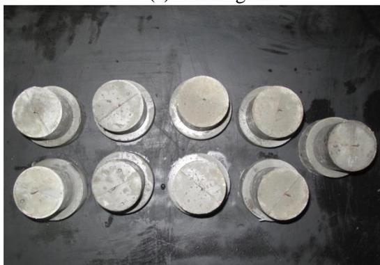
(c) Corpos de prova desmoldados
