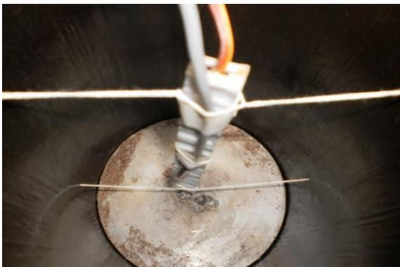
(a) Extensômetros elétricos e termômetros
