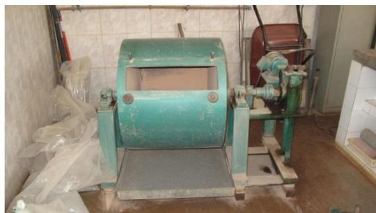
Figura 0.20 – Ensaio de abrasão (a) equipamento “Los Angeles”
