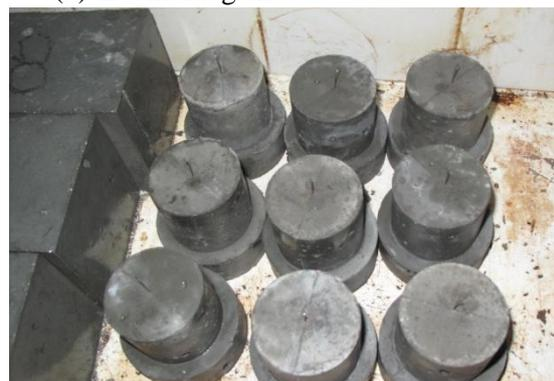
(d) Corpos de prova na câmara úmida
