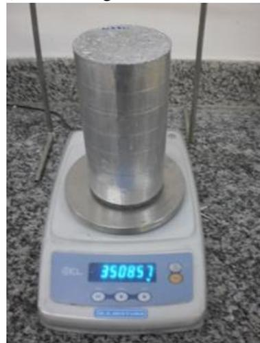
(d) Pesagem dos corpo de prova
