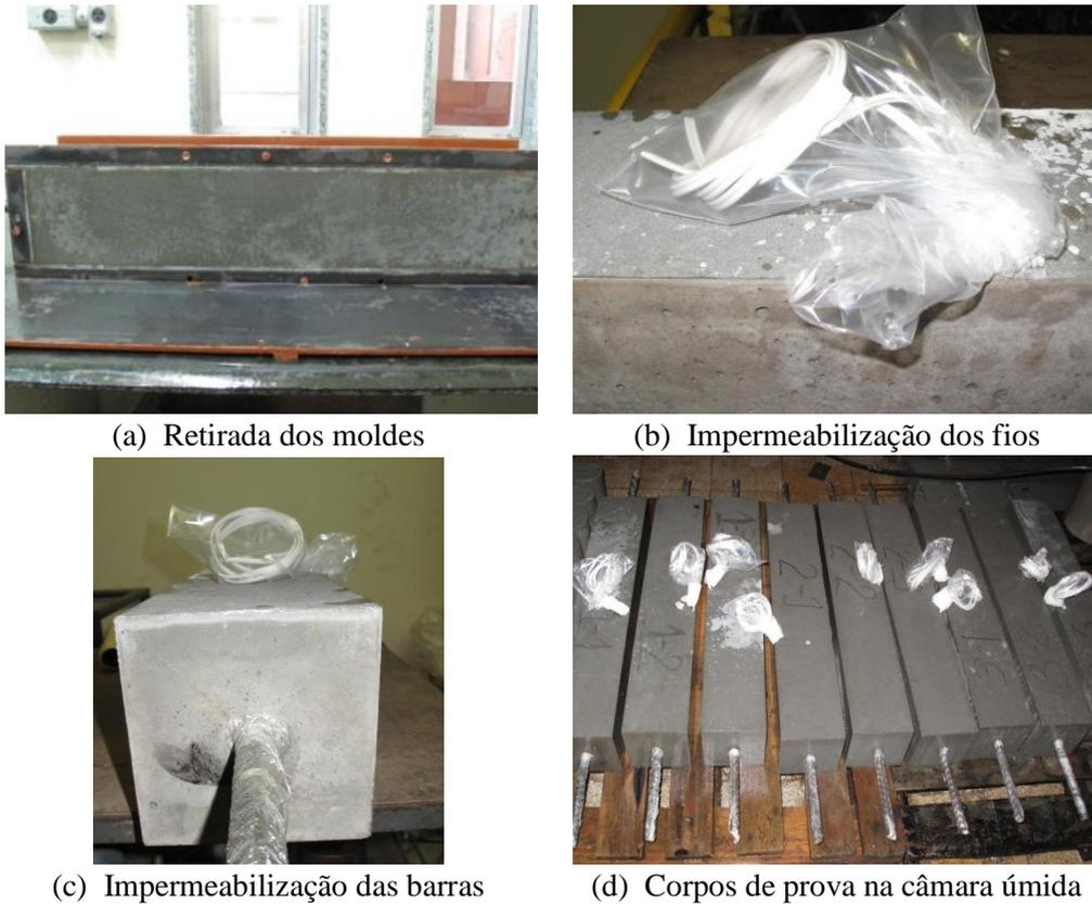
Figura 4.30 – Desmoldagem dos tirantes.
