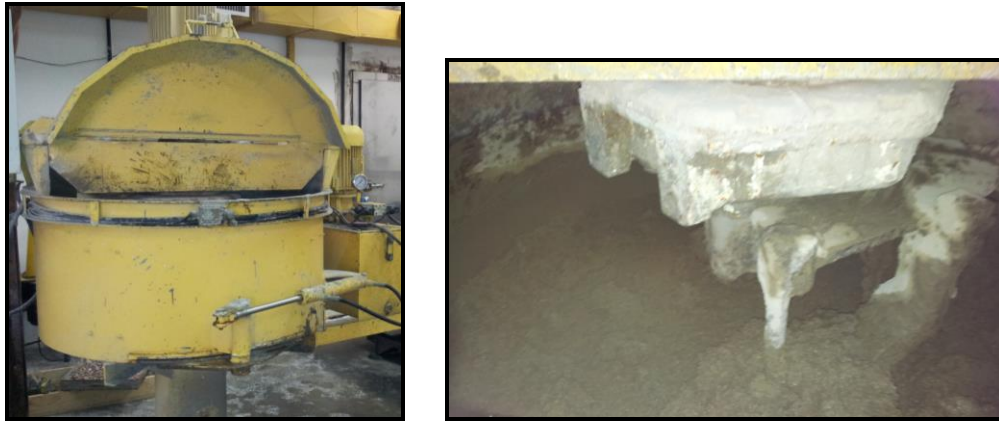
Figura 3-7 Misturador planetário utilizado e a produção da argamassa de referência
