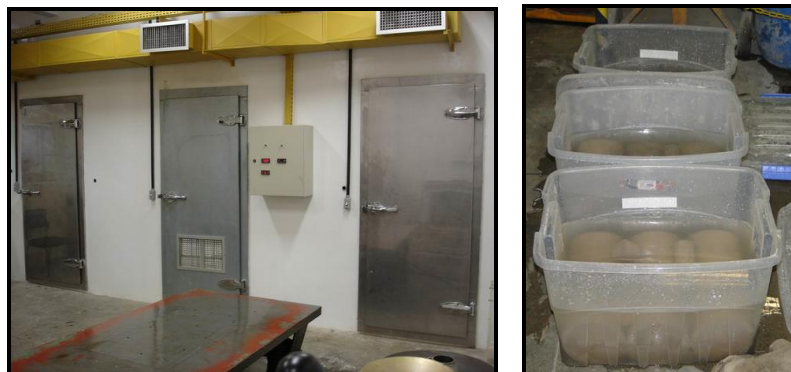
Figura 3-10 Câmara climatizada a temperatura constante de 40 \pm 2^\circ\text{C} para armazenamento de corpos de prova imersos em solução.
