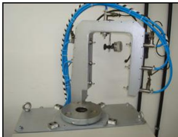
Figura 3-14 Visão do pórtico com LVDTs fixados lateralmente e no topo.
