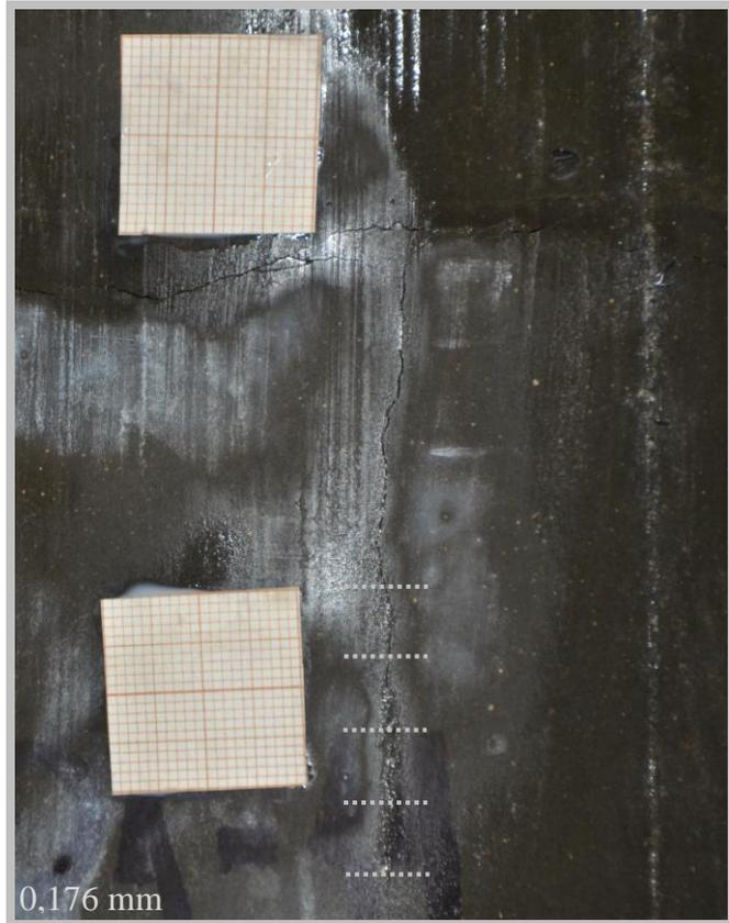
Figura 6.19 – Fissuração CONAD após 2 anos de imersão na solução de NaOH (CP01)
