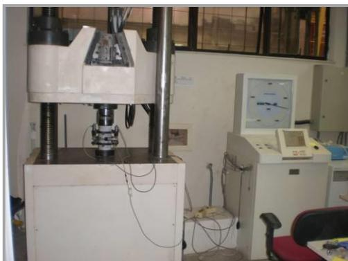
Figura 4.6 – Máquina servo-controlada Shimadzu, com capacidade de 1000kN.
