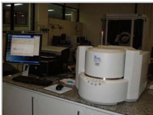
Figura 4.1 – Equipamento EDX 800 utilizado na análise química.
