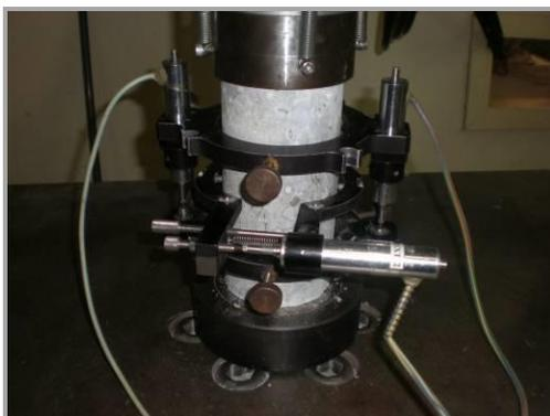
Figura 4.7 – Configuração do ensaio de resistência à compressão.
