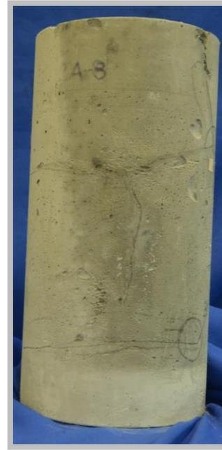
Figura 6.15 – Quadro fissuratório do corpo de prova após 2 anos de imersão na solução de NaOH (CP02).
