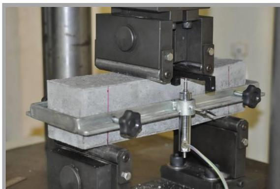
Figura 4.8 – Configuração do ensaio de resistência à tração na flexão conforme a norma NM 55:96.
