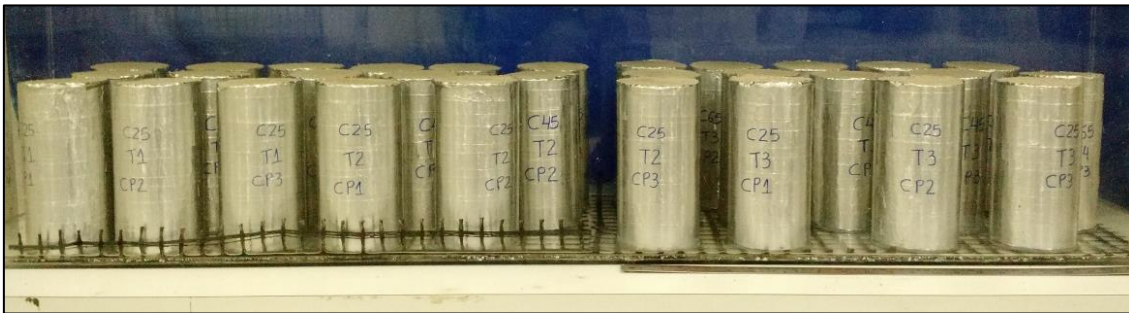
Figura 4.13 – Ensaio de absorção de água por capilaridade
