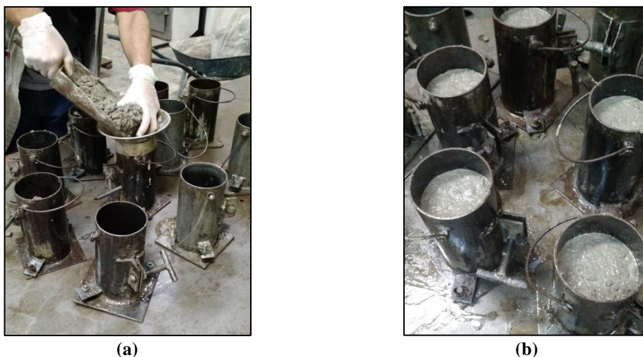
Figura 5.4 – Moldagem dos corpos-de-prova cilíndricos: (a) colocação do material em três camadas; (b) aspecto da segunda camada após vibração
