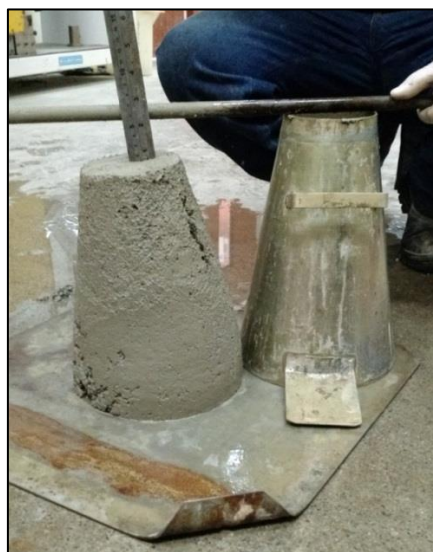
Figura 4.10 – Ensaio de abatimento do tronco de cone
