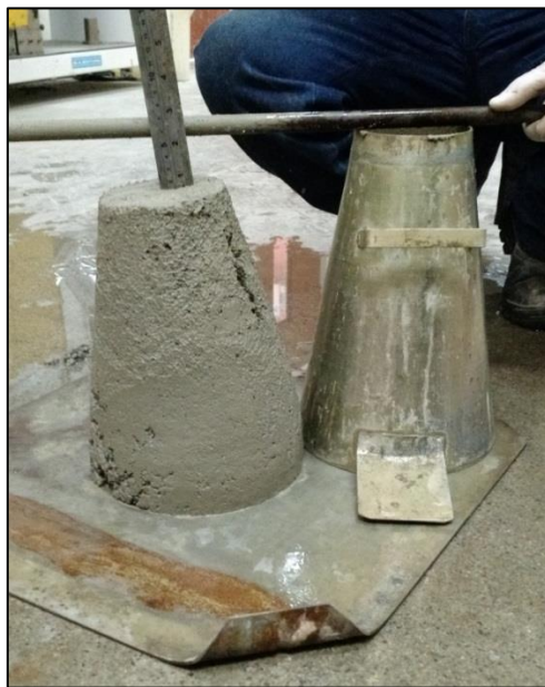
Figura 6.4 – Detalhe do abatimento do tronco de cone obtido para a mistura C25-6080
