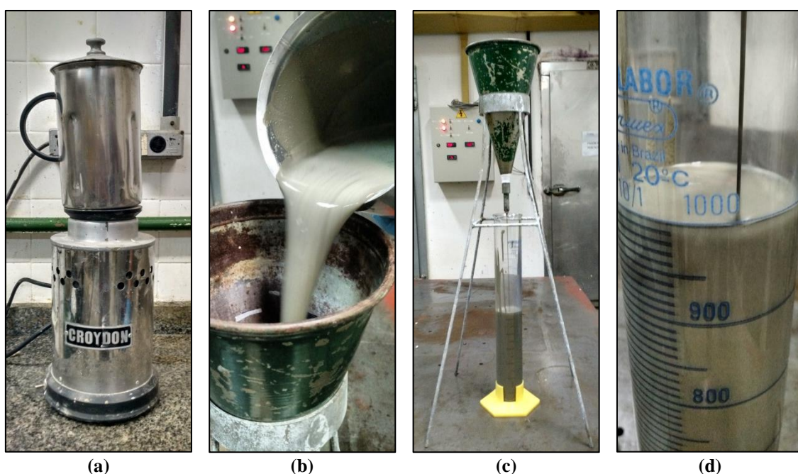
Figura 4.8 – Ensaio de ponto de saturação: (a) misturador utilizado; (b) colocação da pasta no funil de Marsh; (c) detalhe da estrutura do ensaio; (d) detalhe do momento em que 1000 ml de pasta passam pelo funil.
