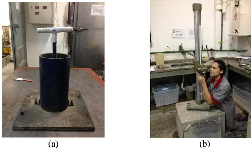
Figura 3.9 – Ensaio de compactação experimental dos agregados: (a) cilindro com material após vibração; (b) leitura da posição do pistão a partir do catetômetro;
