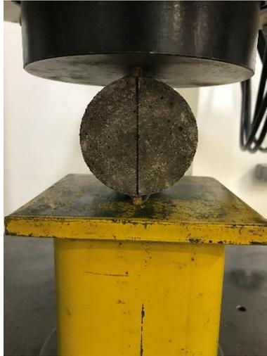
Figura 3.16 – Ensaio resistência à tração por compressão diametral
