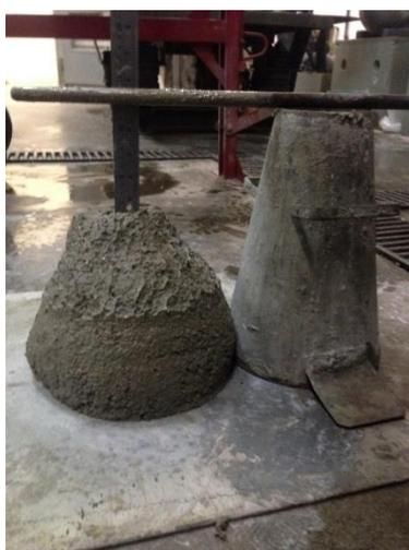
Figura 3.14 – Ensaio de abatimento de tronco de cone
