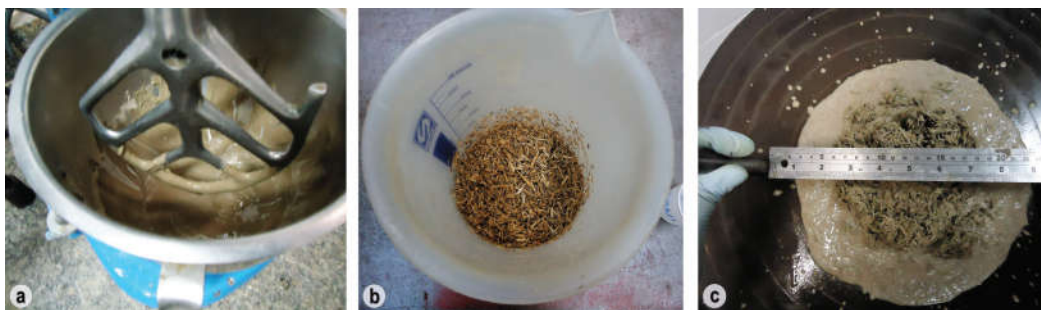
Figura 3.27: Etapas testadas no procedimento 3: (a) início da mistura com pasta, (b) pré saturação das partículas, (c) espalhamento com exsudação e segregação.
