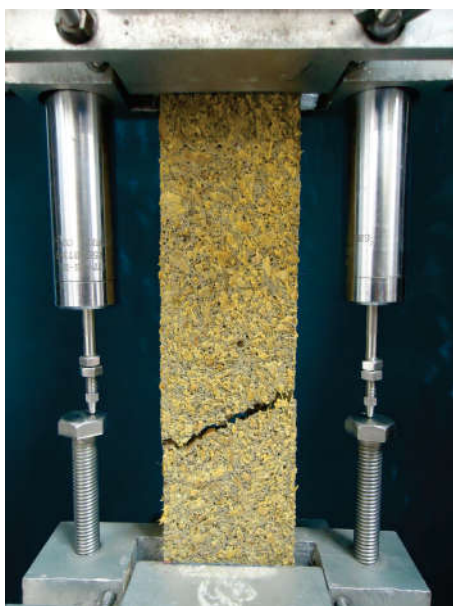
(a) CP fissurado durante o ensaio.
