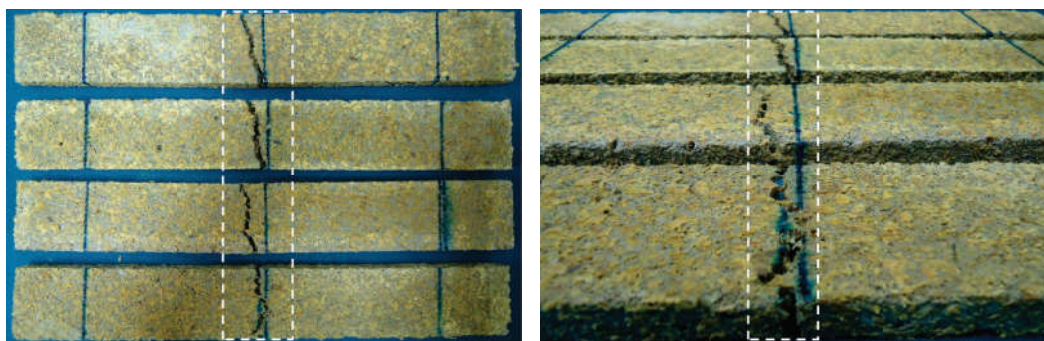
(a) Fratura na região central.
