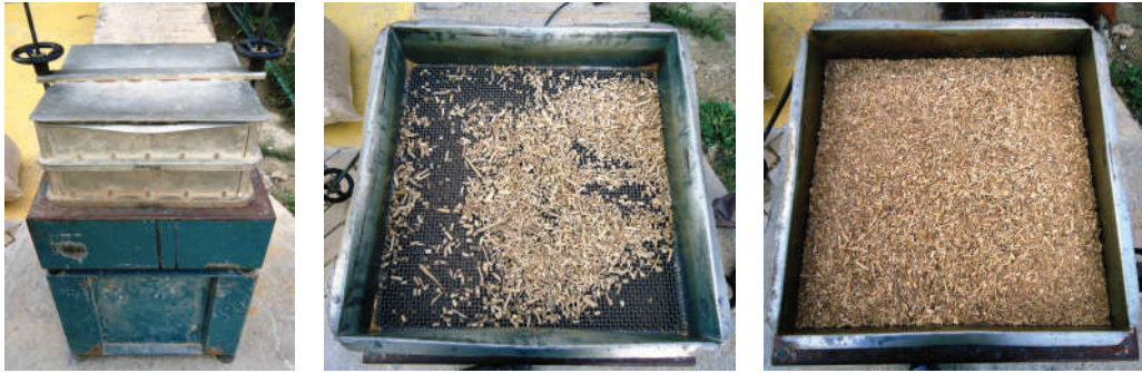
(a) Peneirador mecânico. (b) Material retido na #4,75 mm. (c) Material retido na #1,18 mm.
