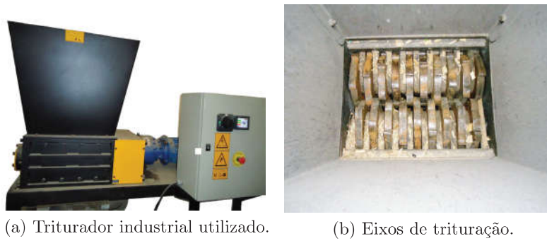
Figura 3.2: Triturador industrial utilizado para trituração das taliscas de bambu.
