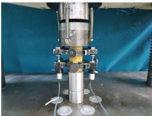
(b) LVDTs montados no corpo - de - prova.
