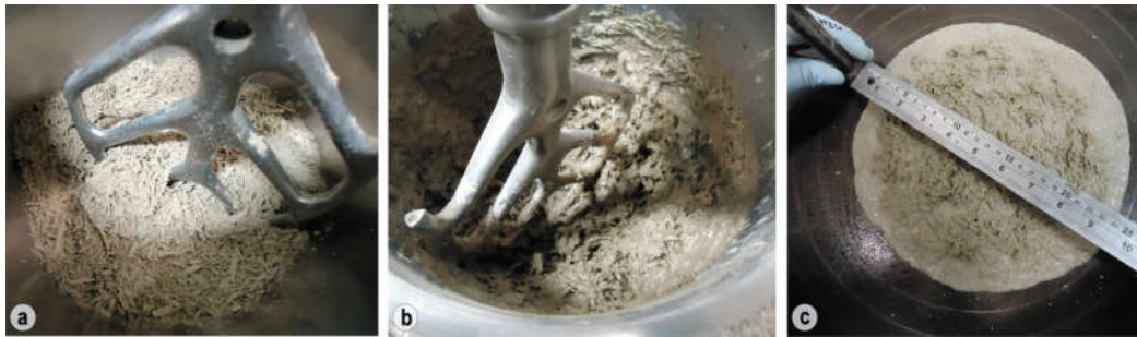
Figura 3.25: Etapas testadas no procedimento 1: (a) mistura dos materiais secos, (b) adição da água no conjunto, (c) teste de espalhamento com presença de segregação.
