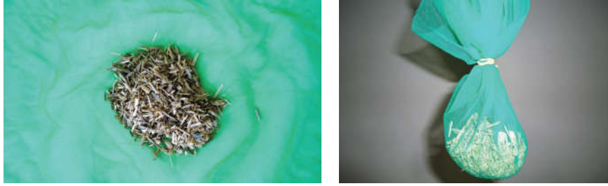
(a) Tecido do tipo filó com bio-agregado. (b) Fechamento do conjunto.
