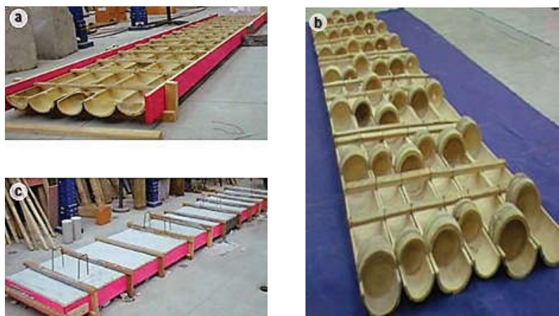
Figura 2.16: (a) Seção transversal do bambu. (b) Diafragma inteiro, reforçado com tiras de bambu e aço. (c) Protótipo finalizado. Adaptado de (NAVARRO, 2002).
