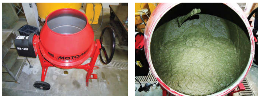
(a) Modelo da betoneira utilizado. (b) Mistura com boa homogeneidade.
