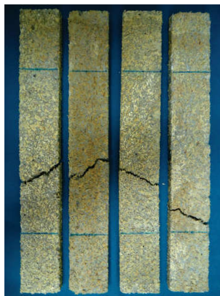
(b) Fissuras do ensaio dentro do L_0 .
