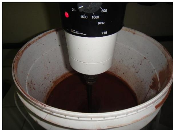
**Figura 3.4: Homogeneização da lama de rejeito com auxílio do agitador mecânico *Fisatom* modelo 715.**
