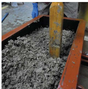
Figura 3.20: a) 1ª camada do compósito cimento madeira colocada em cima do laminado inferior b)Compactação com a haste c)Ajuste final da superfície
