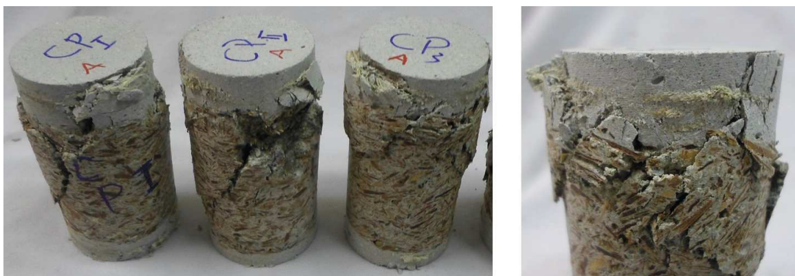
Figura 4.27: a)Corpos de prova CP PS 2,5 rompidos b) Interface face núcleos
