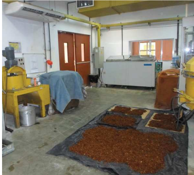
Figura 3.10: Secagem da serragem na sala de 20°C antes da moldagem
