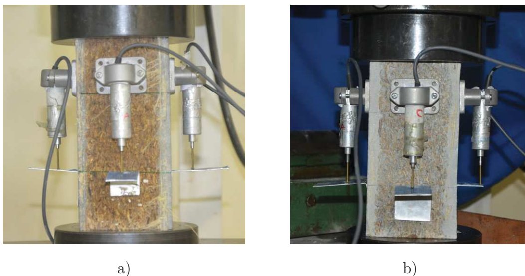
Figura 3.23: Ensaio compressão uniaxial longitudinal a)PS 0,5 b) PS 2,5
