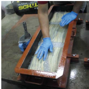
Figura 3.19: a)Espalhamento da 1ª camada de argamassa no fundo do molde b)Colocação da 1ª camada de fibras c)Ajuste manual das fibras d) Colocação da segunda camada de argamassa d) Espalhamento da argamassa com a espatulá
