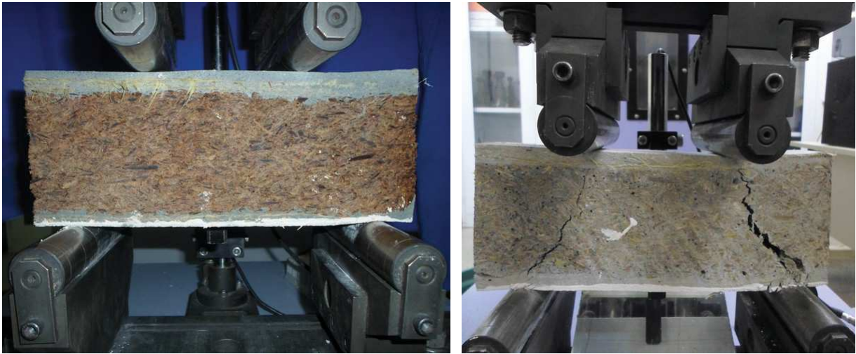
Figura 3.26: Cisalhamento por flexão em 4 pontos a)PS 0,5 b) PS 2,5
