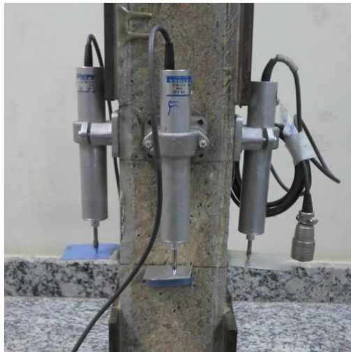
Figura 3.31: Ensaio de tração direta do sanduíche
