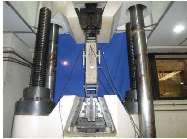
Figura 3.31: Ensaio de tração direta do sanduíche
