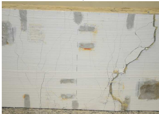
Figura 4.40: PS 2,5 após o ensaio de flexão a) Vista lateral b) Face inferior c) Parte central da face
