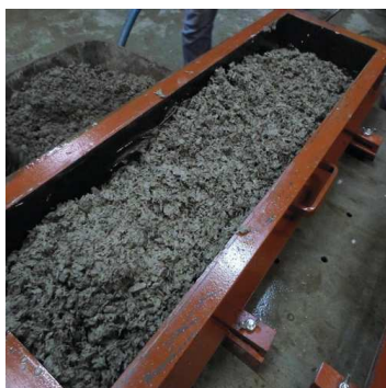
Figura 3.20: a) 1ª camada do compósito cimento madeira colocada em cima do laminado inferior b)Compactação com a haste c)Ajuste final da superfície
