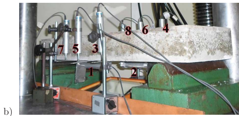
Figura 3.28: Disposição dos 8 LVDTs no painel a ensaiar
