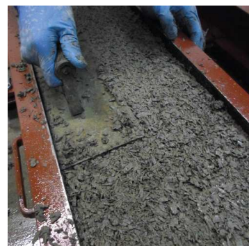
Figura 3.20: a) 1ª camada do compósito cimento madeira colocada em cima do laminado inferior b)Compactação com a haste c)Ajuste final da superfície
