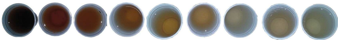
Figura 3.9: Variação da tinta da água depois 9 lavagens
