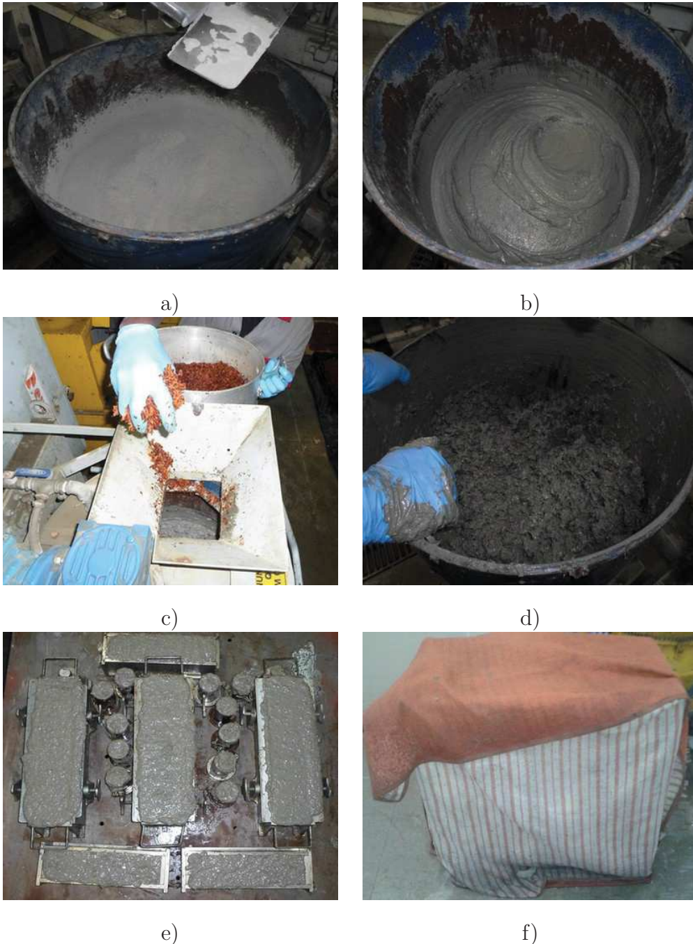
Figura 3.11: a) Lançamento do cimento b) Pasta de cimento c) Lançamento da serra-gem de madeira d) Compósito obtido e) Compósitos colocados nos diferentes moldes e) Manta de proteção contra a perda de umidade
