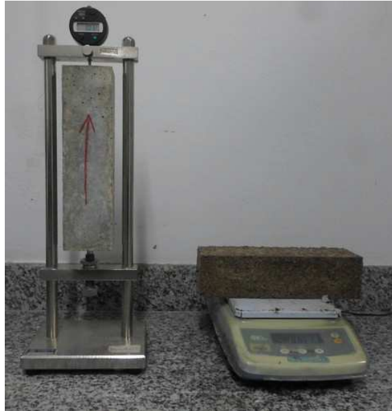
Figura 3.34: Registros de variações: dimensional (esquerda) e de massa (direita)
