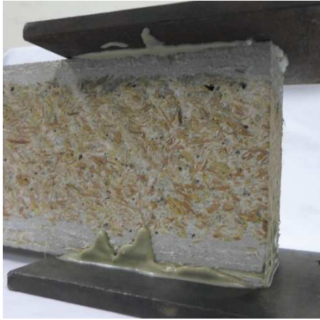
Figura 3.31: Ensaio de tração direta do sanduíche
