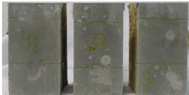
Figura 4.24: Ruptura em compressão a)PS 2,5 Núcleo b)PS 2,5 Faces c) PS 0,5 Núcleo d)PS 0,5 Faces
