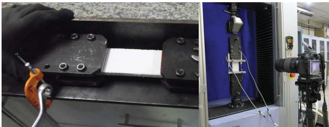
Figura 3.30: a)Fixação do CP b) Ensaio de tração
