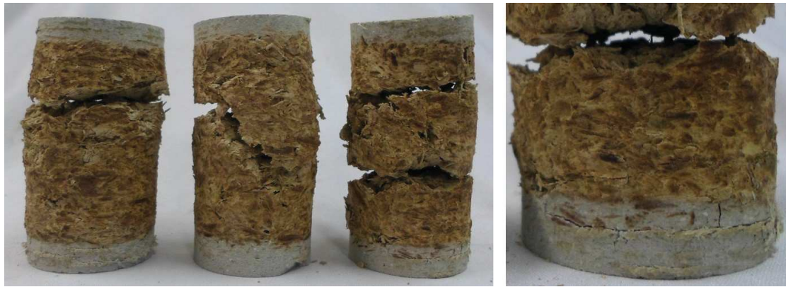
Figura 4.26: a)Corpos de prova CP PS 0,5 rompidos b) Interface face núcleos
