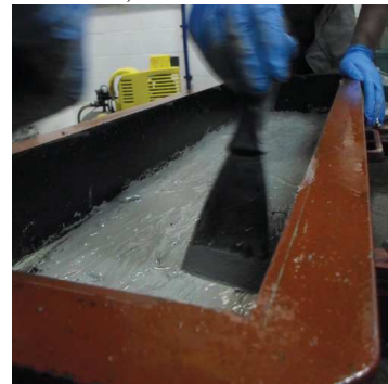
Figura 3.19: a)Espalhamento da 1ª camada de argamassa no fundo do molde b)Colocação da 1ª camada de fibras c)Ajuste manual das fibras d) Colocação da segunda camada de argamassa d) Espalhamento da argamassa com a espatulá
