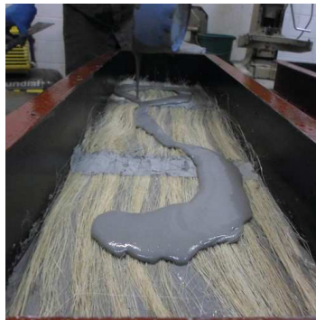
Figura 3.19: a)Espalhamento da 1ª camada de argamassa no fundo do molde b)Colocação da 1ª camada de fibras c)Ajuste manual das fibras d) Colocação da segunda camada de argamassa d) Espalhamento da argamassa com a espatulá
