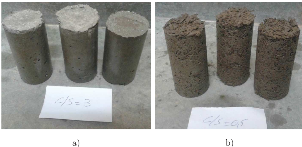
Figura 4.1: CCM após desmoldagem a)CCM3 b)CCM0,5
