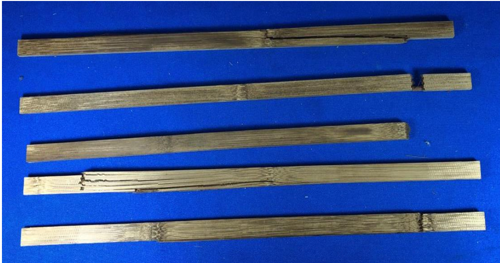
Figura 14 - Plano de ruptura de ripas submetidas à temperatura de 200 °C durante 60 minutos
