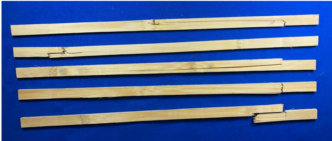
Figura 3 - Plano de ruptura de ripas submetidas à temperatura de 100 °C durante 30 minutos
