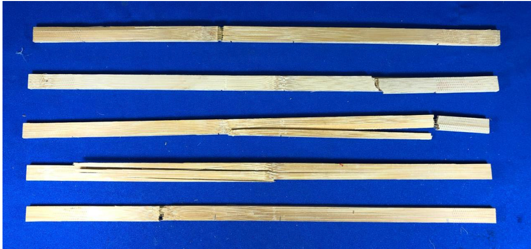
Figura 5- Plano de ruptura de ripas submetidas à temperatura de 100 °C durante 120 minutos
