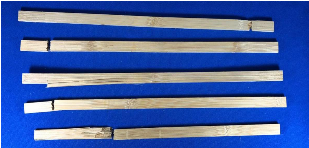
Figura 11 - Plano de ruptura de ripas submetidas à temperatura de 150 °C durante 240 minutos
