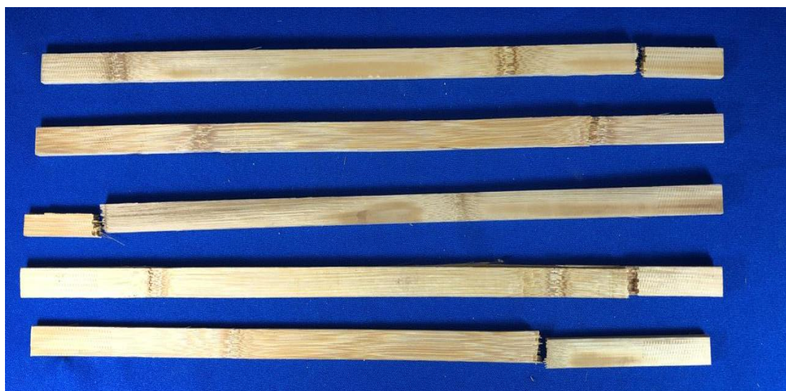
Figura 10- Plano de ruptura de ripas submetidas à temperatura de 150 °C durante 120 minutos
