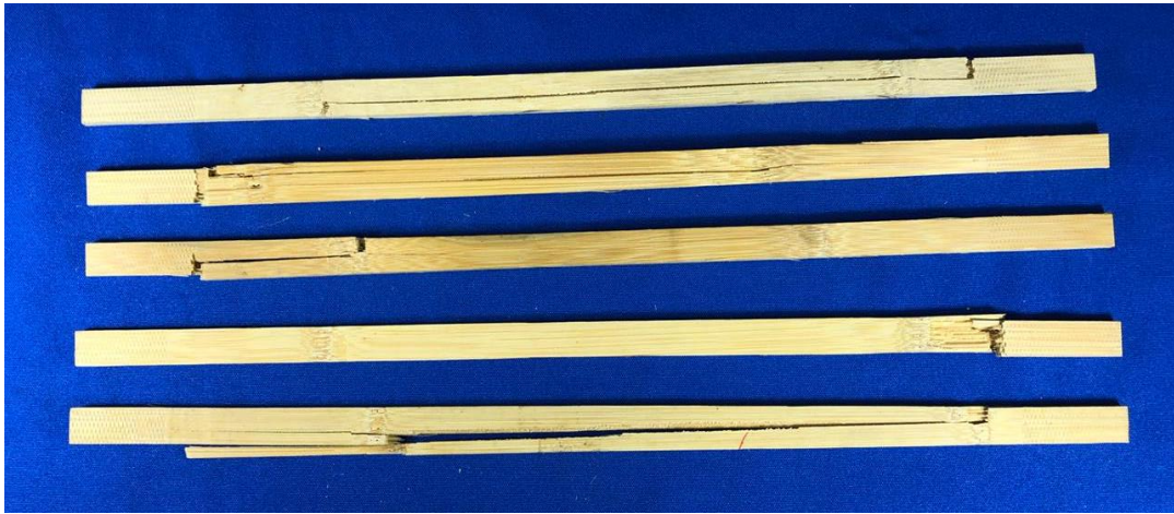
Figura 2 - Plano de ruptura de ripas submetidas à temperatura de 100 °C durante 15 minutos
