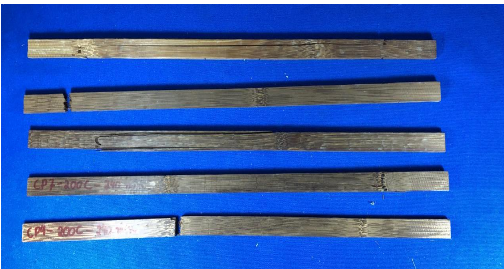
Figura 16 - Plano de ruptura de ripas submetidas à temperatura de 200 °C durante 240 minutos
