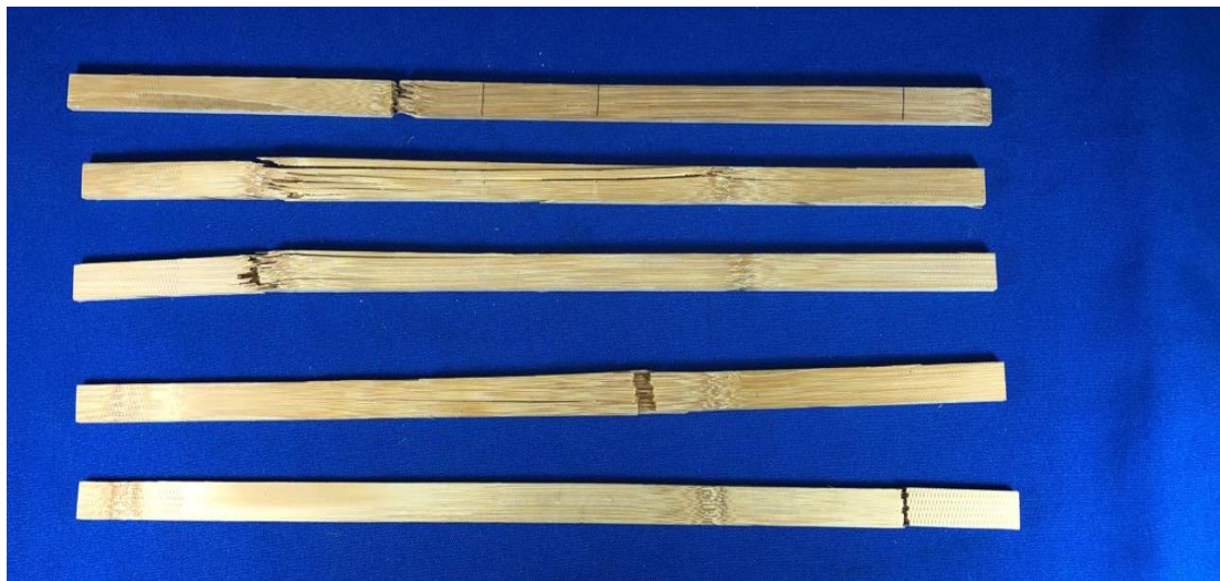
Figura 9- Plano de ruptura de ripas submetidas à temperatura de 150 °C durante 60 minutos
