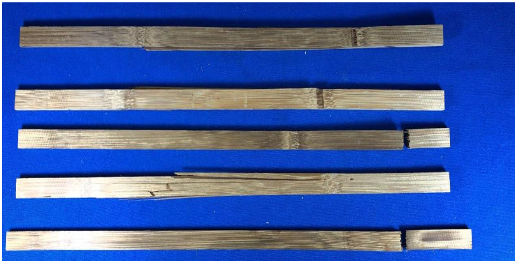
Figura 12- Plano de ruptura de ripas submetidas à temperatura de 200 °C durante 30 minutos
