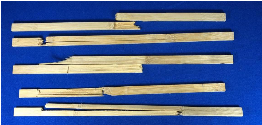
Figura 8 - Plano de ruptura de ripas submetidas à temperatura de 150 °C durante 30 minutos
