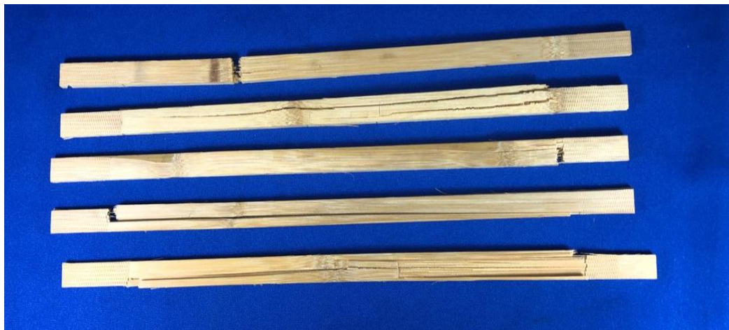
Figura 7 - Plano de ruptura de ripas submetidas à temperatura de 150 °C durante 15 minutos
