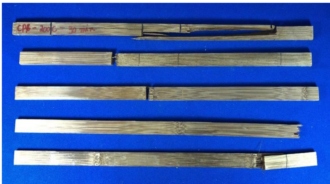
Figura 13- Plano de ruptura de ripas submetidas à temperatura de 200 °C durante 30 minutos
