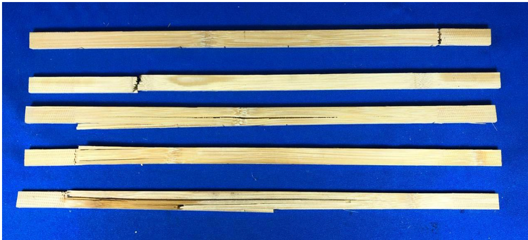
Figura 6- Plano de ruptura de ripas submetidas à temperatura de 100 °C durante 240 minutos
