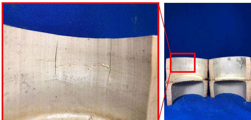
Figura 3.19 – Interferência da presença de nó no plano de ruptura – DHCN
