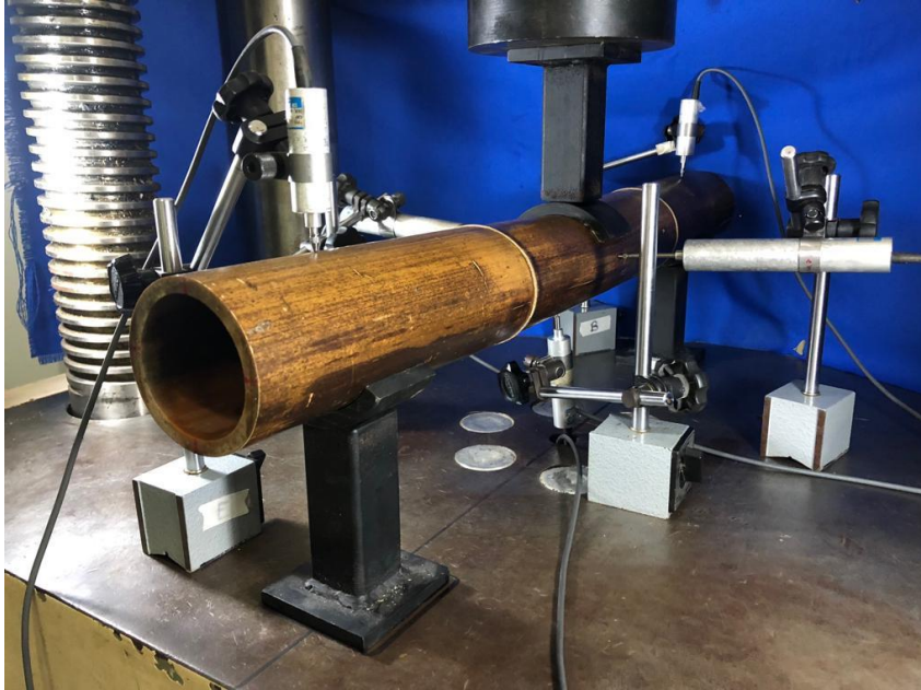
Figura 3.24- Esquema do ensaio de flexão em três pontos no estado totalmente saturado
