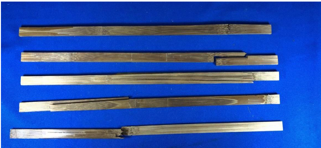
Figura 15 - Plano de ruptura de ripas submetidas à temperatura de 200 °C durante 120 minutos
