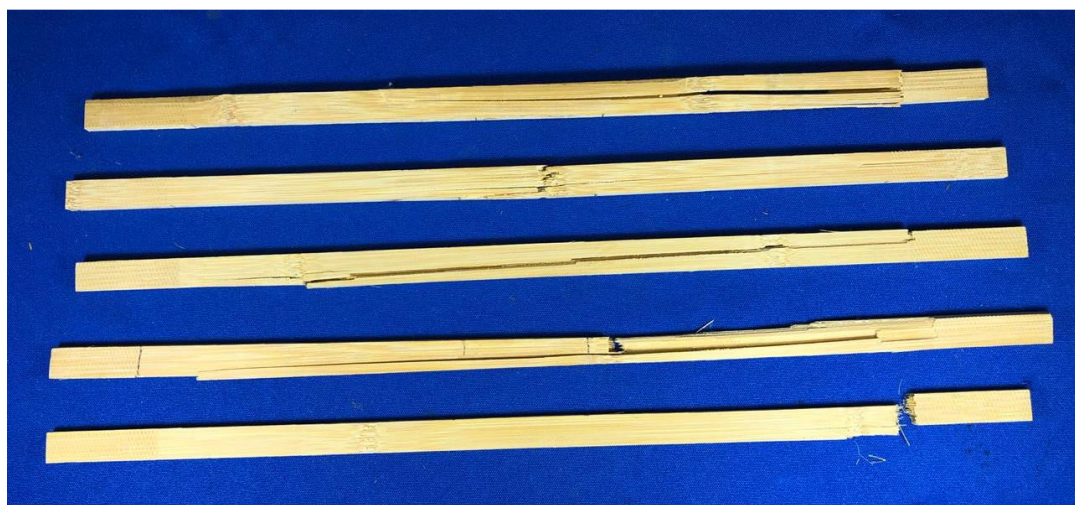
Figura 4- Plano de ruptura de ripas submetidas à temperatura de 100 °C durante 60 minutos
