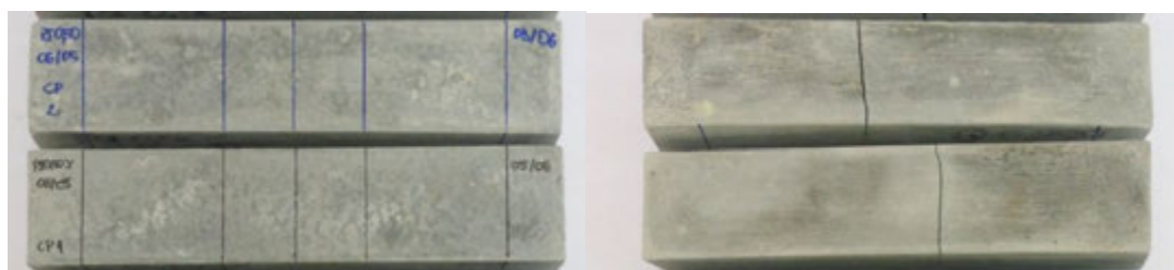
Figura 4.45 – Modo de ruptura dos corpos-de-prova da mistura PI 0,50%.
