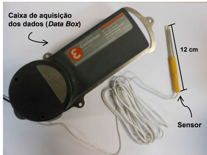
Figura 3.28 – Equipamento ConSensor 2.0 com um sensor conectado.
