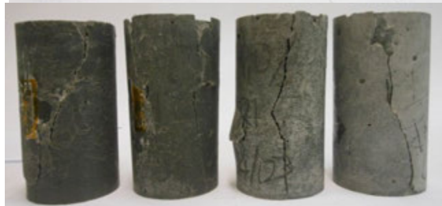
Figura 4.37 – Modo de ruptura das misturas com fibras de pinho no ensaio de compressão triaxial com confinamento de 4,14 MPa.
