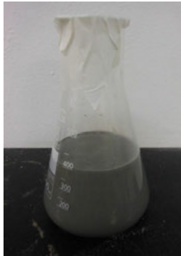
Figura 3.19 - Ensaio de água livre.
