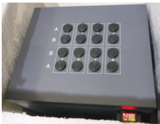
Figura 3.31 - Calorímetro TAM Air (TA Instruments) do Laboratório de Estruturas e Materiais da COPPE/UFRJ.
