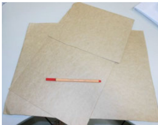
Figura 3.15 – Fibra de pinho em forma acartonada.
