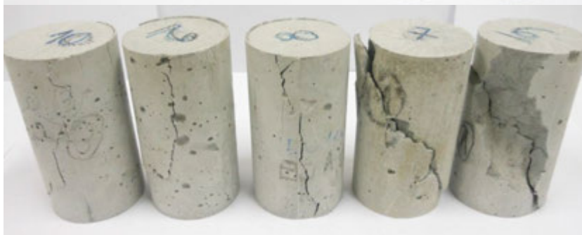
Figura 7.10 – Modo de ruptura das misturas com fibras de eucalipto e a referência no ensaio de compressão uniaxial aos 7 dias.
