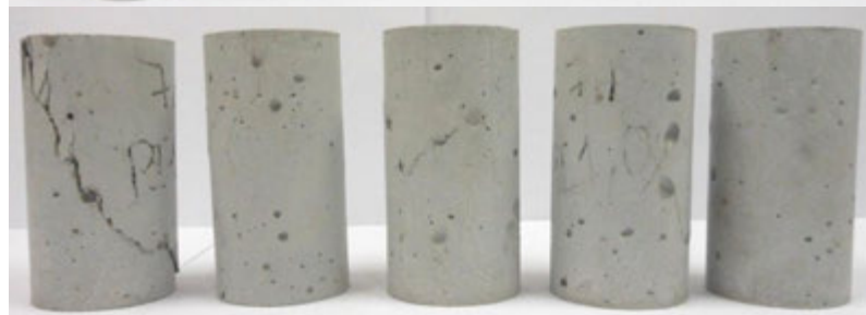
Figura 7.11 – Modo de ruptura das misturas com fibras de pinho no ensaio de compressão uniaxial aos 7 dias.
