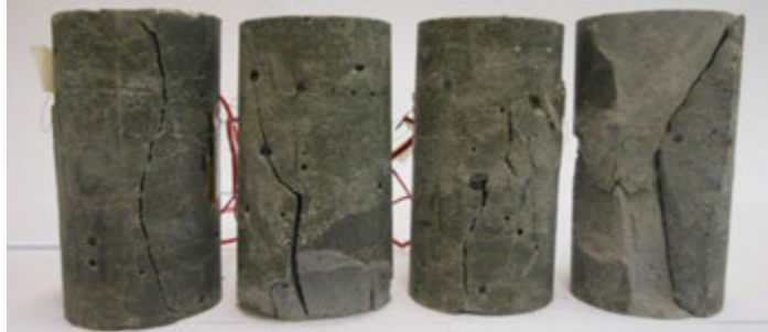
Figura 4.36 – Modo de ruptura das misturas com fibras de eucalipto e a referência no ensaio de compressão triaxial com confinamento de 4,14 MPa.
