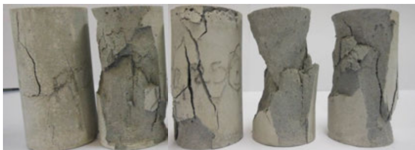
Figura 7.14 – Modo de ruptura das misturas com fibras de eucalipto e a referência no ensaio de compressão uniaxial aos 90 dias.
