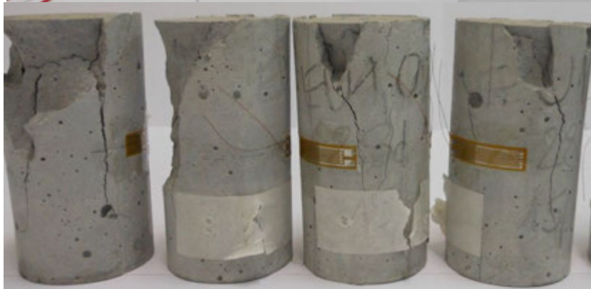
Figura 7.12 – Modo de ruptura das misturas com fibras de eucalipto e a referência no ensaio de compressão uniaxial aos 28 dias.
