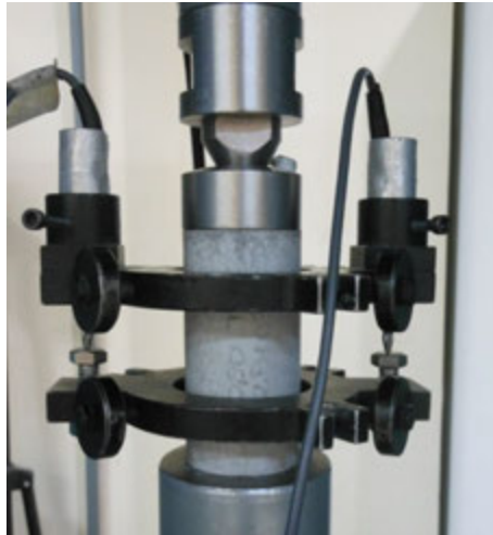
Figura 3.35 – Configuração do ensaio de compressão uniaxial.
