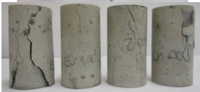
Figura 7.14 – Modo de ruptura das misturas com fibras de eucalipto e a referência no ensaio de compressão uniaxial aos 90 dias.
