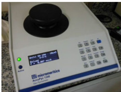
Figura 3.1 - Picnômetro a gás AccuPyc 1340 da Micromeritics®.
