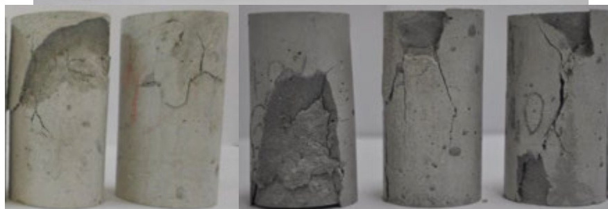
Figura 7.15 – Modo de ruptura das misturas com fibras de pinho no ensaio de compressão uniaxial aos 90 dias.
