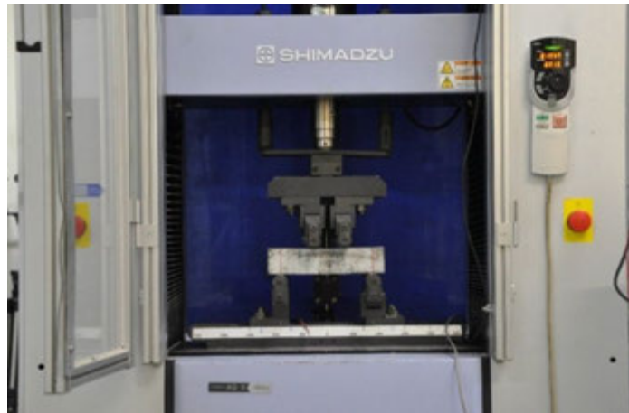
Figura 3.39 - Configuração dos ensaios de resistência à tração na flexão.
