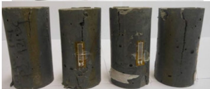
Figura 7.24 – Modo de ruptura das misturas com fibras de pinho no ensaio de compressão triaxial com confinamento de 8,28 MPa.
