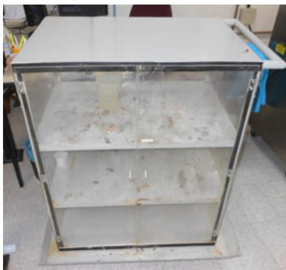
Figura 3.18 – Câmara de cura dos corpos-de-prova durante as primeiras 24 horas.
