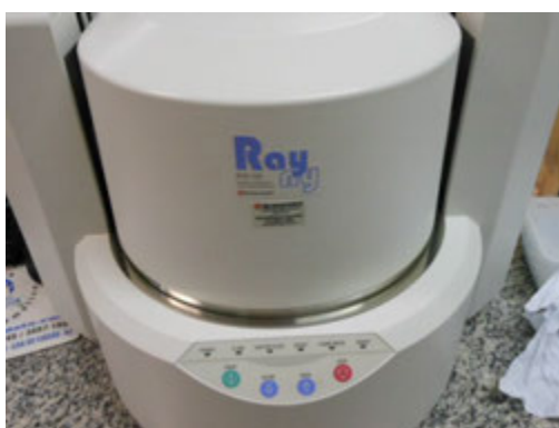
Figura 3.4 - Equipamento Shimadzu® Modelo EDX 720 Rayny utilizado para determinação das composições químicas.
