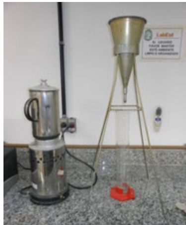
Figura 3.11 – Ensaio de compatibilidade e ponto de saturação pelo cone Marsh.
