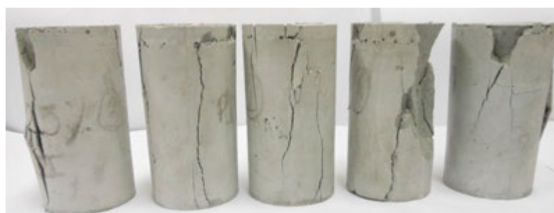
Figura 7.10 – Modo de ruptura das misturas com fibras de eucalipto e a referência no ensaio de compressão uniaxial aos 7 dias.
