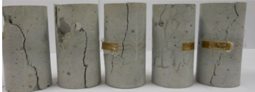
Figura 7.22 – Modo de ruptura das misturas com fibras de pinho no ensaio de compressão triaxial sem confinamento.
