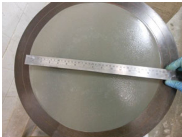
Figura 3.20 - Ensaio de espalhamento na mesa de consistência padrão.
