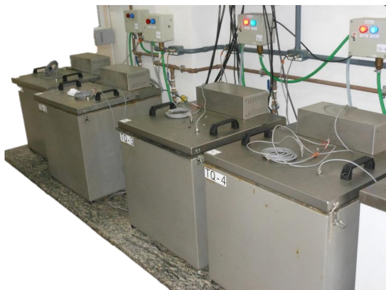
Figura 3.26 – Calorímetros adiabáticos do Laboratório de Estruturas e Materiais da COPPE/UFRJ.
