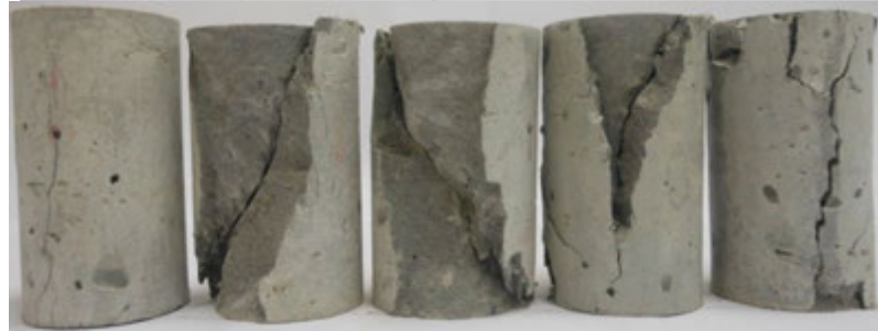
Figura 7.17 – Modo de ruptura das misturas com fibras de pinho no ensaio de compressão uniaxial aos 180 dias.
