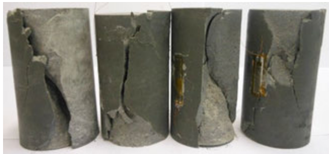
Figura 4.36 – Modo de ruptura das misturas com fibras de eucalipto e a referência no ensaio de compressão triaxial com confinamento de 4,14 MPa.
