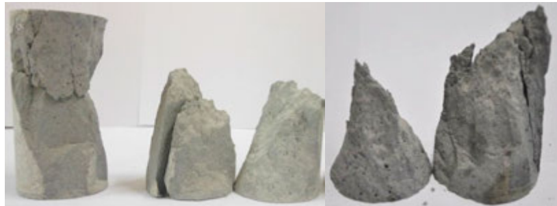
Figura 7.13 – Modo de ruptura das misturas com fibras de pinho no ensaio de compressão uniaxial aos 28 dias.
