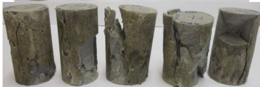
Figura 7.16 – Modo de ruptura das misturas com fibras de eucalipto e a referência no ensaio de compressão uniaxial aos 180 dias.
