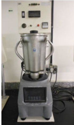
Figura 3.17 – Misturador Chandler utilizado para o preparo das misturas.
