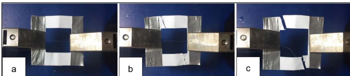
Figura 3.9: Sequência de procedimentos para o teste de tração das fibras: (a) amostra presa pelas garras ainda com o papel, (b) papel da amostra é cortado nas extremidades, (c) amostra após realização do ensaio ainda fixada nas garras.
