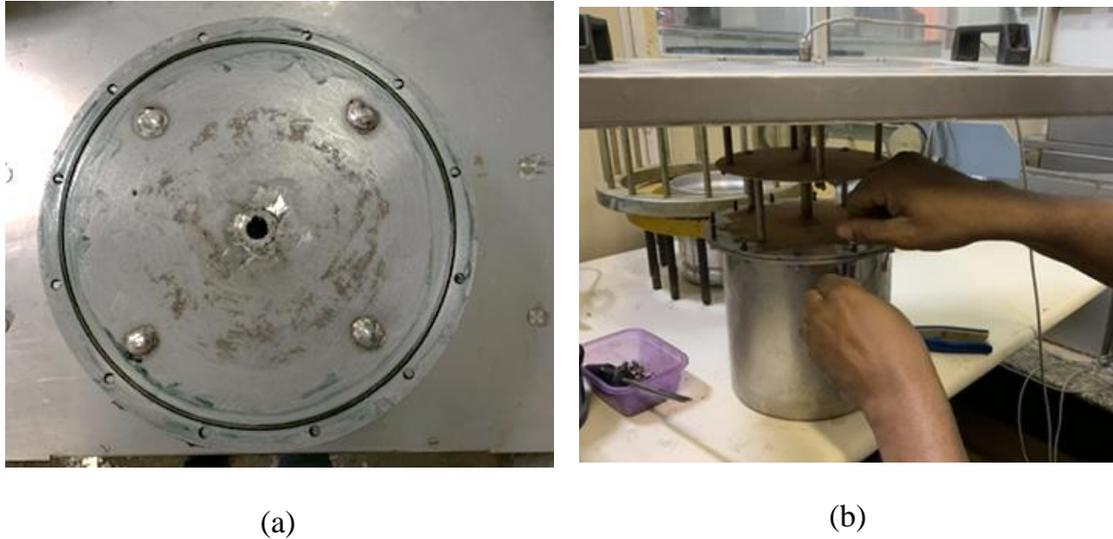
Figura 46 - Fechando o calorímetro adiabático (a) tampa do calorímetro; (b) câmara interna sendo fechada
