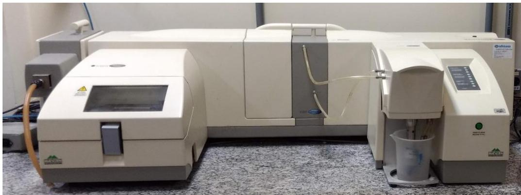
Figura 29 - Equipamento de granulometria à laser: Malvern Mastersizer
