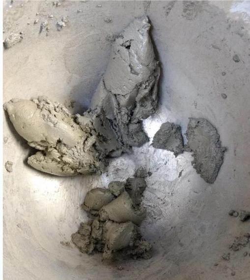
Figura 36 - Estado capilar (máximo empacotamento das partículas)
