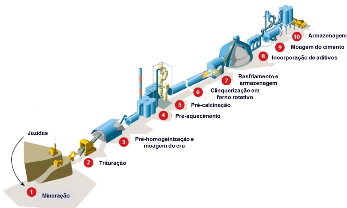
Figura 2.2 - Processo de produção do cimento Portland
