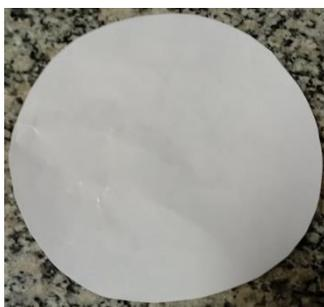
Figura 3.18: Membrana NP010 P para nanofiltração
