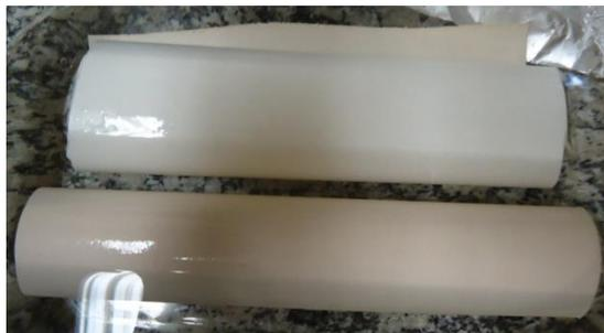
Figura 3.17: Membrana SW30-2540 para osmose inversa
