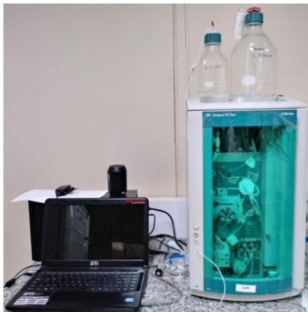
Figura 3.22: Cromatógrafo iônico
