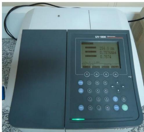
Figura 3.21: Espectrofotômetro modelo UV-1800
