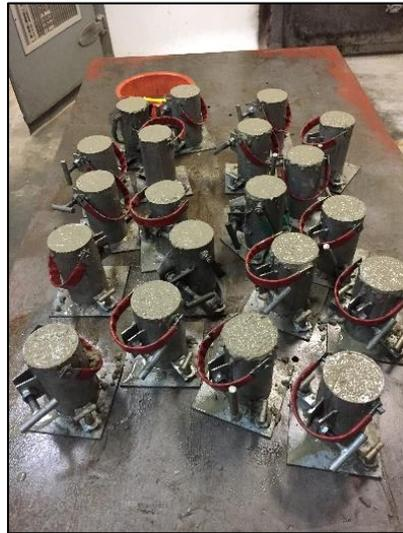
**Figura 4.25 – Adensamento dos corpos-de-prova em mesa vibratória**
