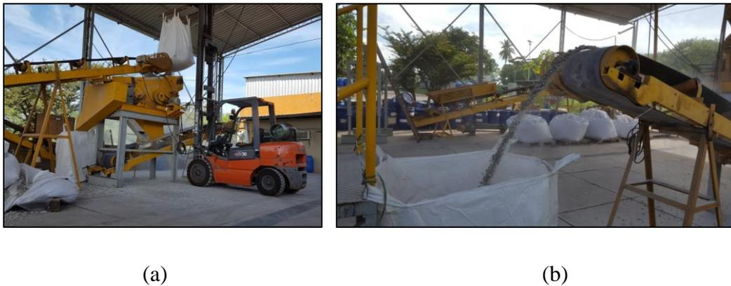
**Figura 4.6 – Processo de peneiramento mecânico do material grosso: (a) detalhe do equipamento (b) detalhe de uma saída do peneirador. Fonte: Amario *et al.*, 2018**
