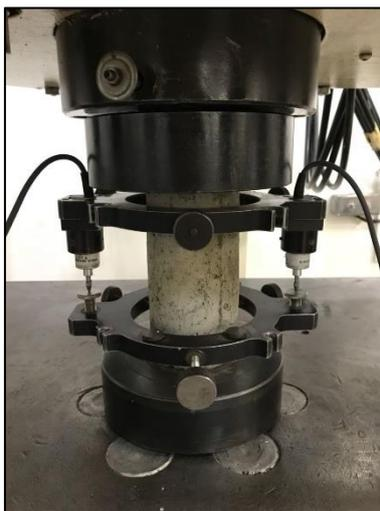
Figura 4.27 – Ensaio de compressão axial dos concretos na Shimadzu UH F-1000kN
