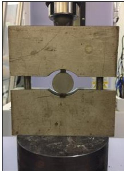
**Figura 4.24 – Ensaio de compressão diametral**
