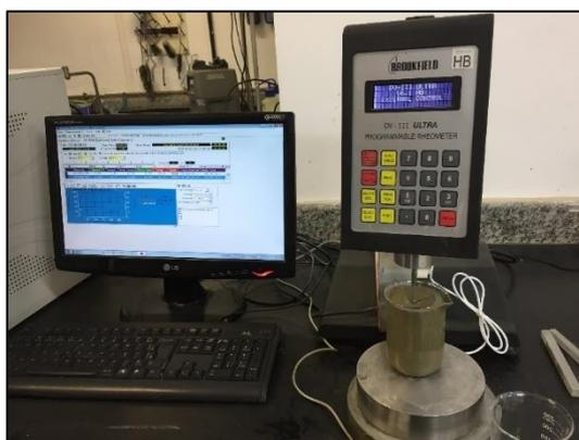
**Figura 4.15 – Equipamento Brookfield modelo DV-III Ultra**
