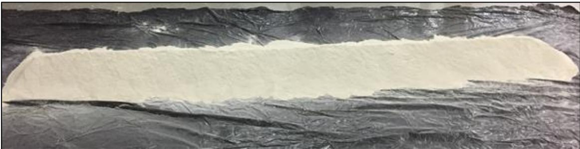
**Figura 4.8 – Homogeneização pelo método de pilha alongada**
