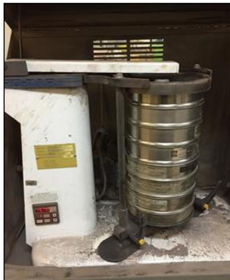
**Figura 4.9 – Peneirador mecânico TYLER RO-TAP8”**
