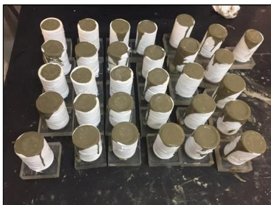
Figura 4.14 – Moldagem dos corpos-de-prova
