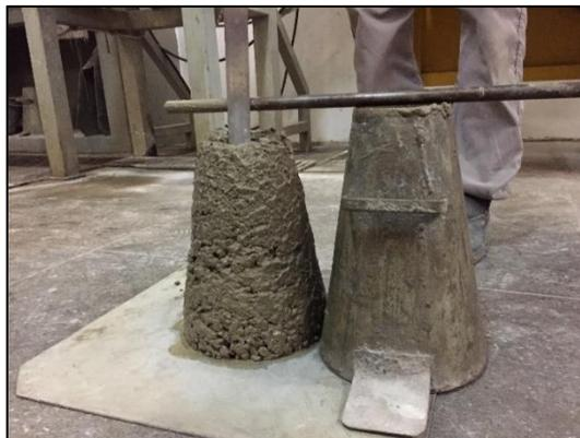
**Figura 4.26 – Medição do abatimento de tronco de cone.**
