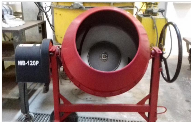
Figura 4.1 - Misturador utilizado na produção dos concretos.
