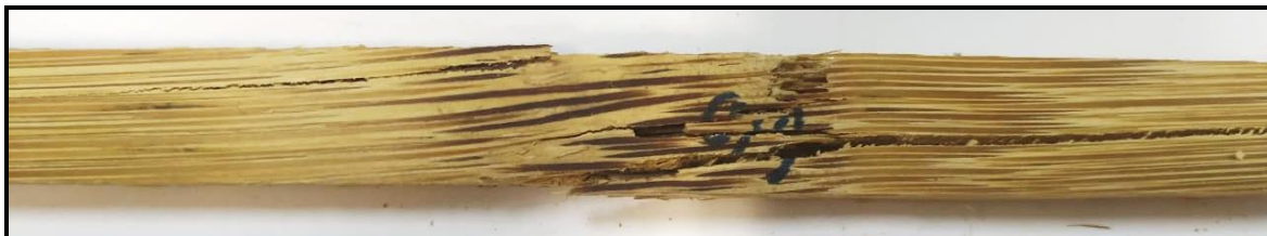
Figura 4.4- Modo de ruptura ripas com nó.
