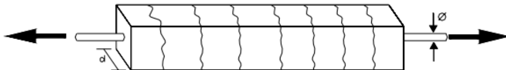
Figura 2.20 -Ensaio de Tirantes de Concreto. Fonte: França (2004)
