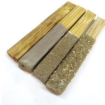
Figura 3.28- Ripas tratadas utilizados no ensaio de arrancamento.
