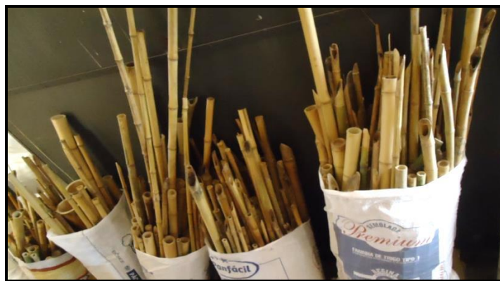
Figura 3.10- Resíduos de bambu utilizados na presente pesquisa.
