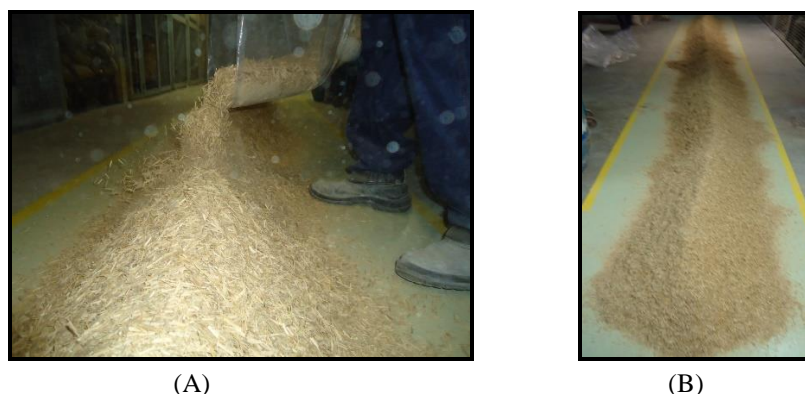
Figura 3.16- Homogeneização dos agregados de bambu: A) Preparo da pilha alongada de agregado de bambu; B) Pilha de agregado finalizada.
