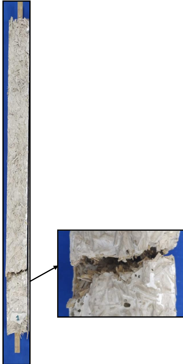
Figura 4.34- Fissuras apresentadas nos tirantes após ensaio: 45%.
