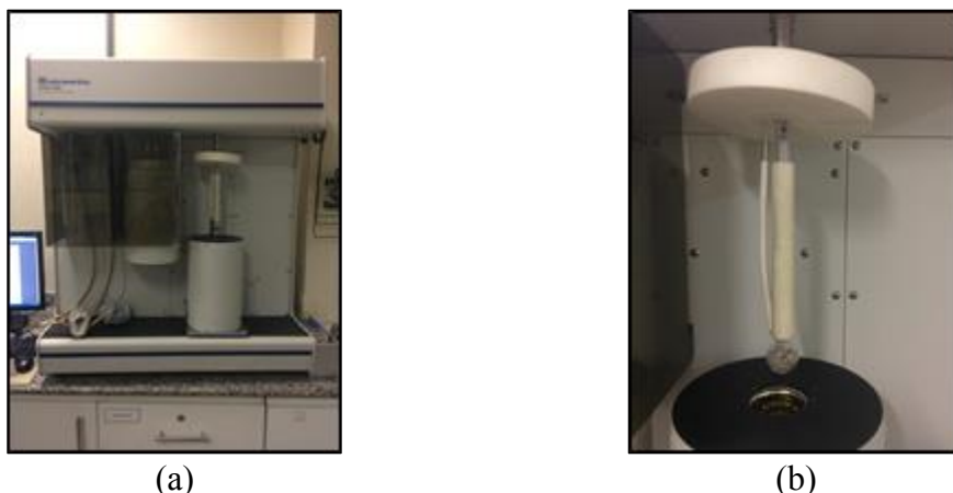
Figura 21: Aparelho ASAP 2020 da marca Micromeritics (a); detalhe da amostra tratada (b) (NUMATS/Labest/COPPE/UFRJ).
