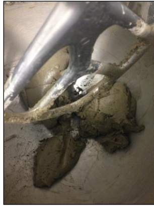
Figura 27: Compacidade experimental pelo método de demanda de água. Em detalhe é possível ver o surgimento das três folhas, indicando que o ponto de demanda de água foi atingido.
