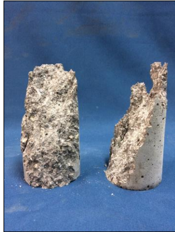
Figura 79: Ruptura do tipo cisalhante em um dos corpos de prova de resistência à compressão.
