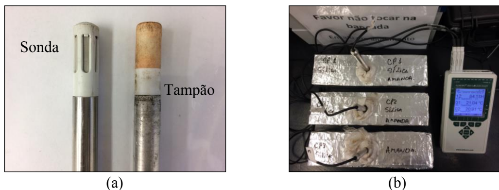
Figura 44: Sonda capacitativa (a); set up do ensaio de umidade interna (b).
