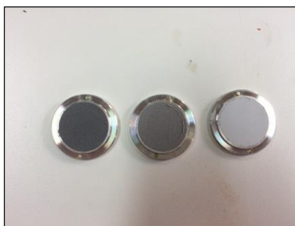
Figura 23: Detalhe das cinzas da casca de arroz e sílica ativa dentro do porta amostra.
