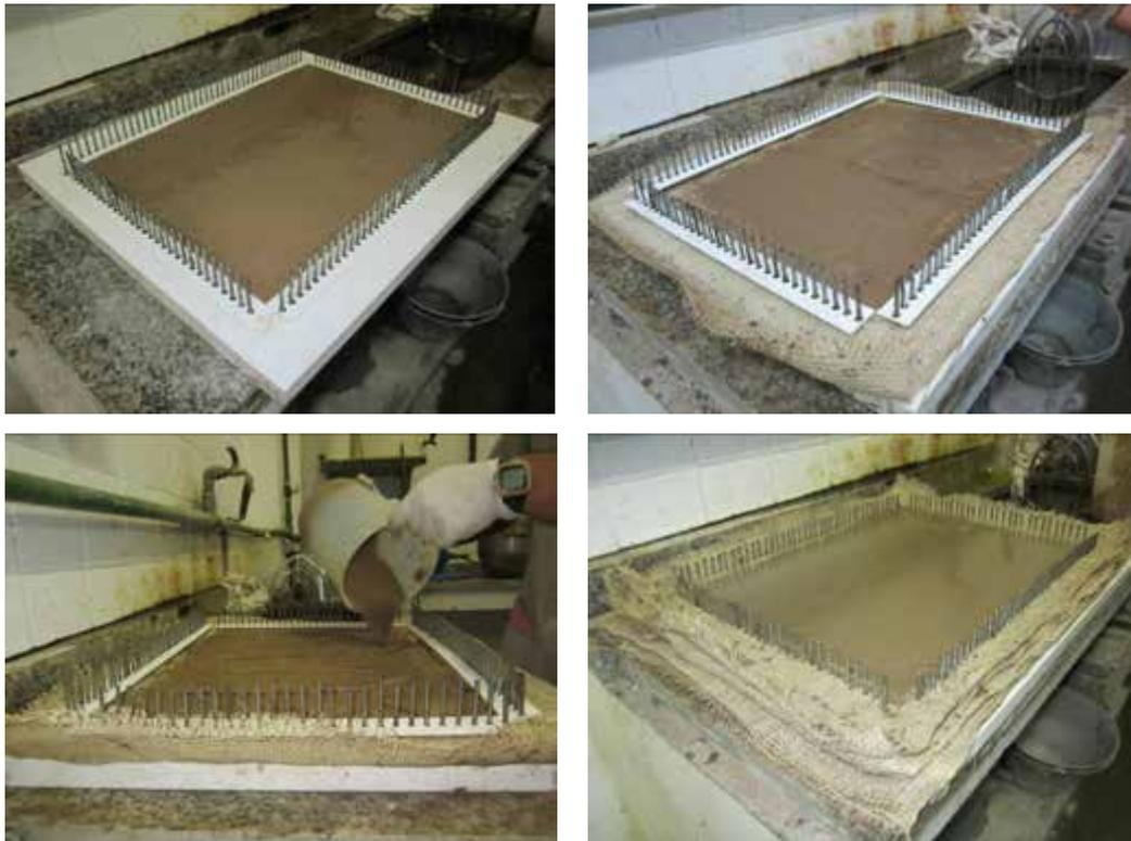
Figura 7.3 – Processo de moldagem dos compósitos têxteis.
