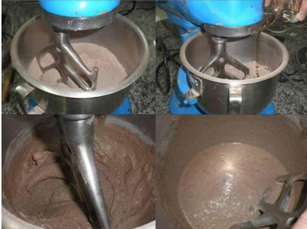
Figura 3.4 – Preparação das misturas para o ensaio de consistência padrão (25MK 25CV).
