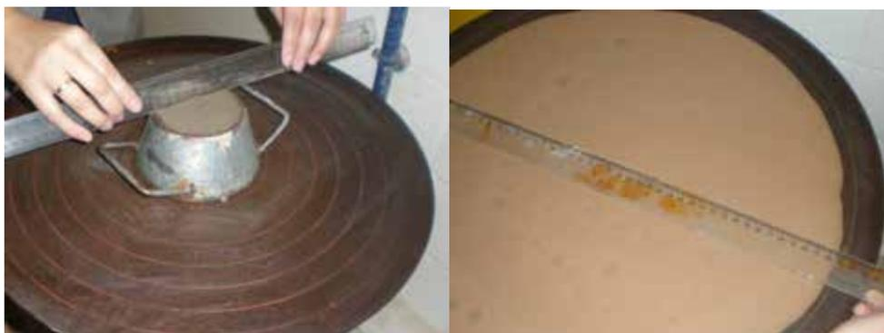
Figura 3.5 – Ensaio de consistência da matriz 25MK 25CV.
