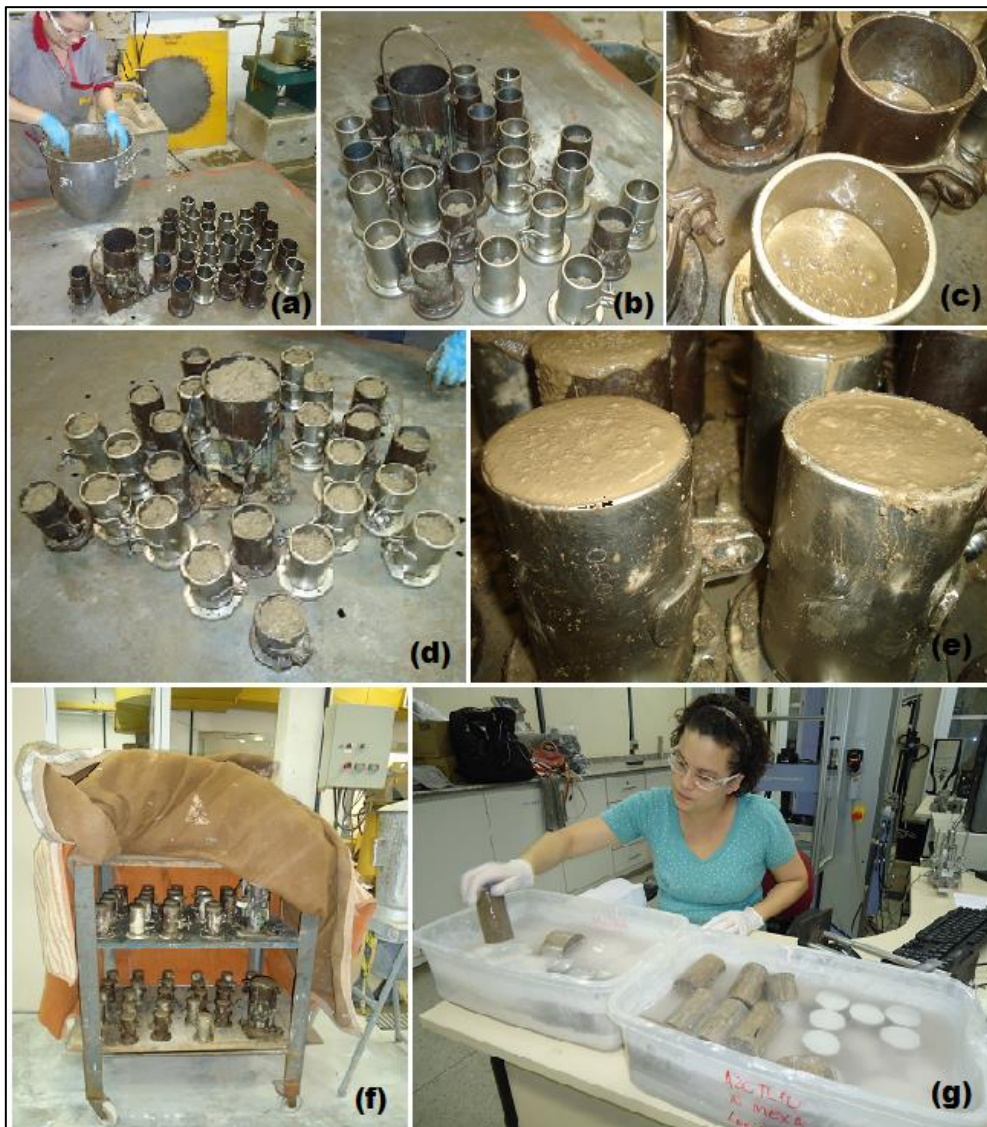
Figura 3.33 (a) Moldes sobre a mesa vibratória prontos para preenchimento; (b) Moldes preenchidos com a primeira camada; (c) primeira camada após vibração; (d) Moldes preenchidos com a segunda camada; (e) Moldes após a vibração da segunda camada; (f) Moldes armazenados cobertos com manta e (g) Corpos de prova imersos em água com cal
