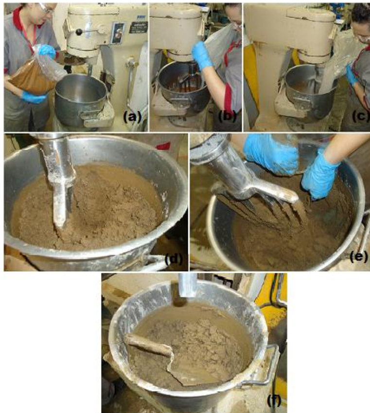
Figura 3.27 (a) Cuba com água e adicionando a polpa, (b) o cimento, (c) a areia, (d) mistura em velocidade alta, (e) parada para limpeza das bordas, (f) a argamassa ao final da mistura
