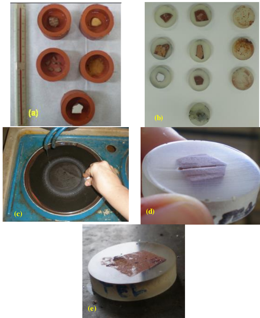
Figura 3.11 Procedimento de preparação das amostras para o DUH. (a) Moldagem das pastilhas de resina; (b) desmoldagem; (c) polimento da superfície com amostra; (d) Sentido das ranhuras após sequência de lixamento e (e) superfície acabada após polimento na lixa # 2400
