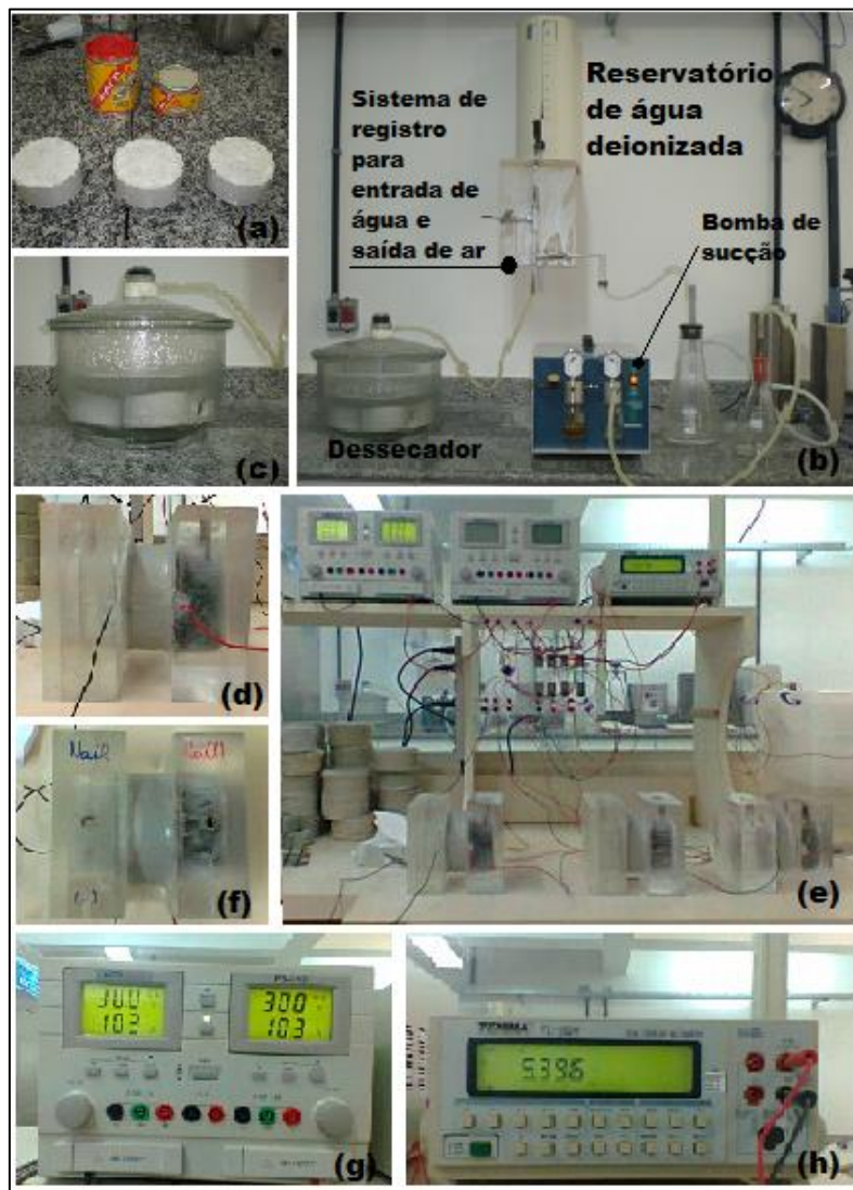
Figura 3.36 (a) Selagem dos discos; (b) Sistema para saturação dos discos; (c) Discos após vácuo e saturação com água; (d) Discos colados com silicone entre duas células de acrílico com eletrodos; (e) Ligação dos eletrodos ao capacitor; (g) Capacitor com 60V ligado em série e (h) Medidor de voltagem
