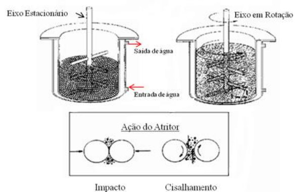
Figura 2.5 Moinho agitado atritor Szegvari (a) e o mecanismo de funcionamento e as forças exercidas no moinho atritor (b) (FLORES, 2010)
