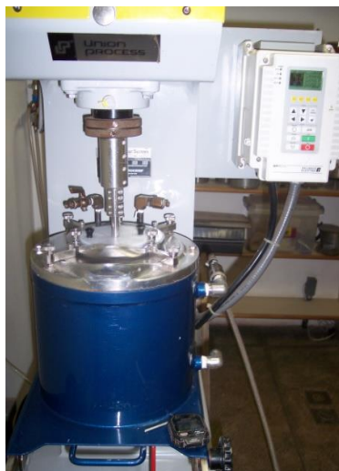
Figura 2.5 Moinho agitado atritor Szegvari (a) e o mecanismo de funcionamento e as forças exercidas no moinho atritor (b) (FLORES, 2010)
