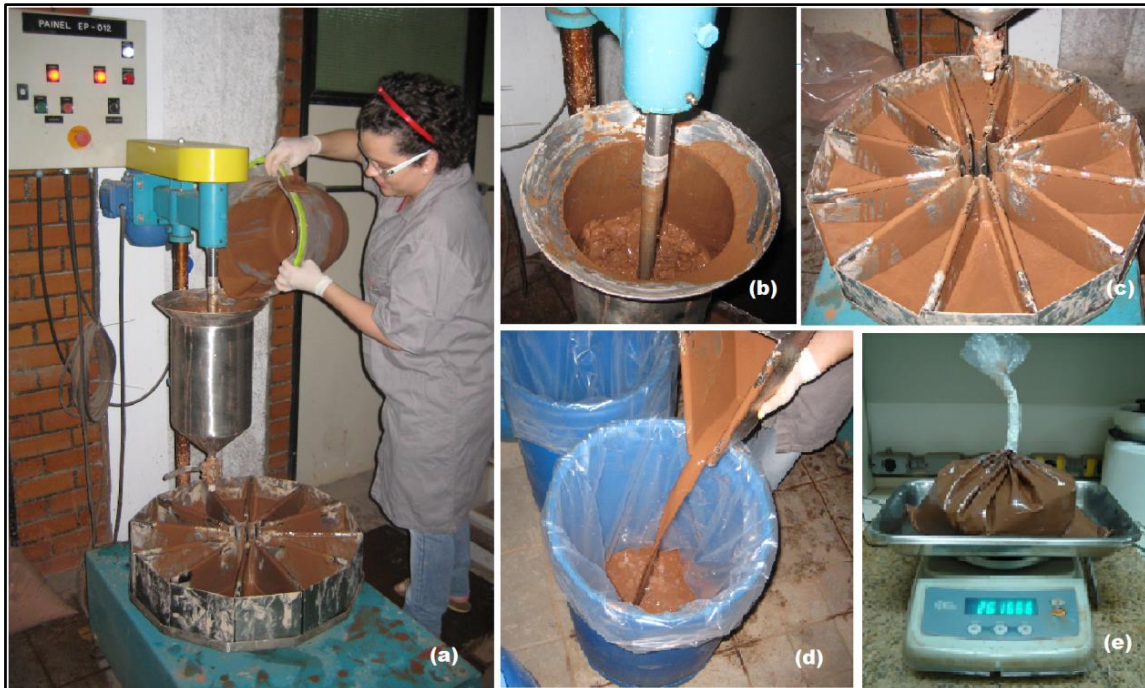
Figura 3.23 (a) Divisor Rotativo de polpa EP-012 Série 2560; (b) Funil com a polpa sendo homogeneizada por uma agitador de hélice; (c) saída do funil com válvula aberta despejando a polpa nas canecas em movimento; (d) retirada das canecas e esvaziamento das mesma em sacos para armazenar as polpas e (e) sacos com a polpa para armazenamento
