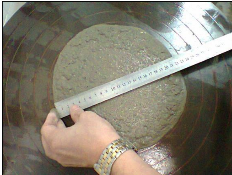
Figura 3.32 Espalhamento da argamassa CTRL obtido na mesas de consistência padrão
