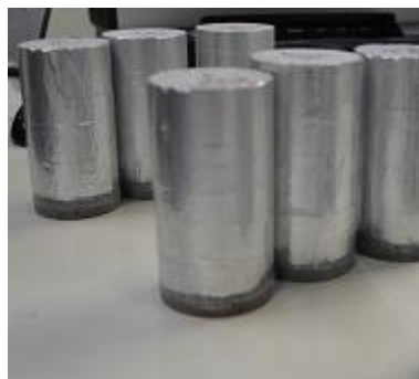
Figura 3.39 Corpos de prova de 50 x 100 mm envolvidos por fita colante de alumínio deixando 5 mm descoberto na base
