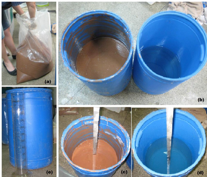
Figura 3.22 (a) Mistura e homogeneização das polpas obtidas ao final de todas as moagens de cada material; (b) Determinação do volume da polpa utilizando quantidade de água equivalente; (c) Medição da profundidade da polpa no tambor; (d) Quantidade de água com a mesma profundidade da polpa determinada e (e) Medição da quantidade de água equivalente ao volume da polpa com auxílio de proveta graduada de 2000ml
