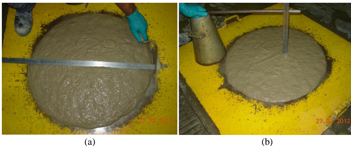
Figura 5.4 - Inserção de fibras de 20 mm de comprimento no teor de 1,0% (a) ensaio de espalhamento (cone de Abrams) e (b) ensaio de abatimento (cone de Abrams).
