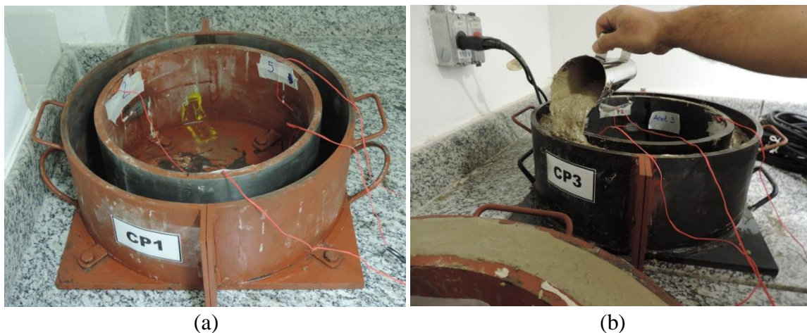
Figura 6.2 – Etapas da moldagem para o ensaio de retração restringida com o compósito: (a) colocação de extensômetros na face interna do anel interno e montagem dos anéis na base (b) preenchimento do molde com a mistura fibrosa.
