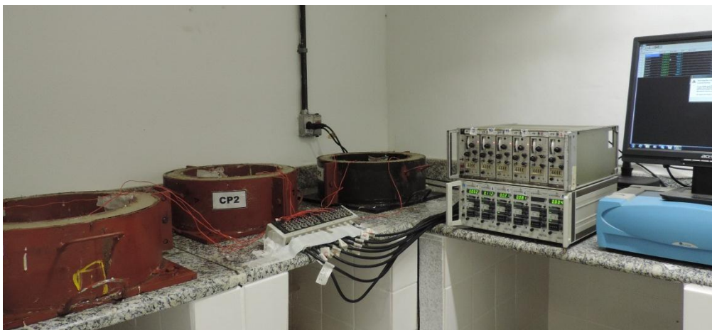
Figura 6.8 – Configuração dos ensaios de retração restringida por anel de aço.
