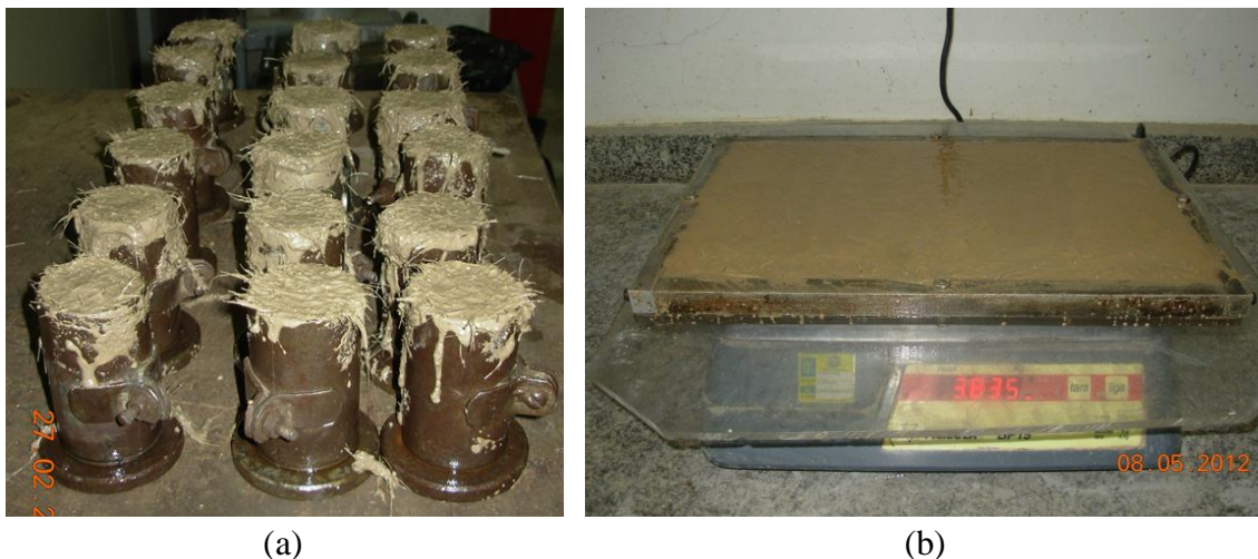
Figura 5.3 - (a) moldagem para ensaios de compressão e (b) moldagem para ensaios de tração e flexão.
