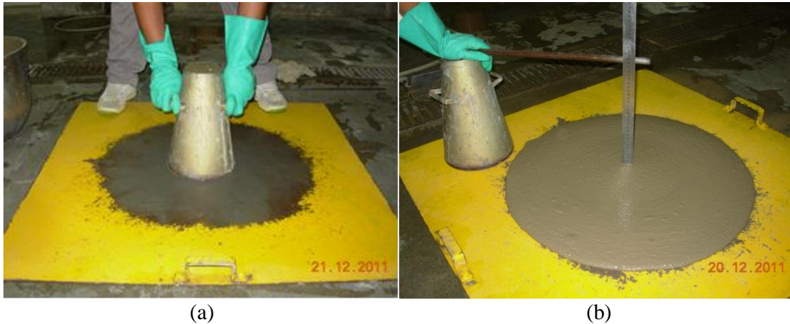
Figura 4.1 - Determinação da consistência pelo abatimento do tronco de cone.
