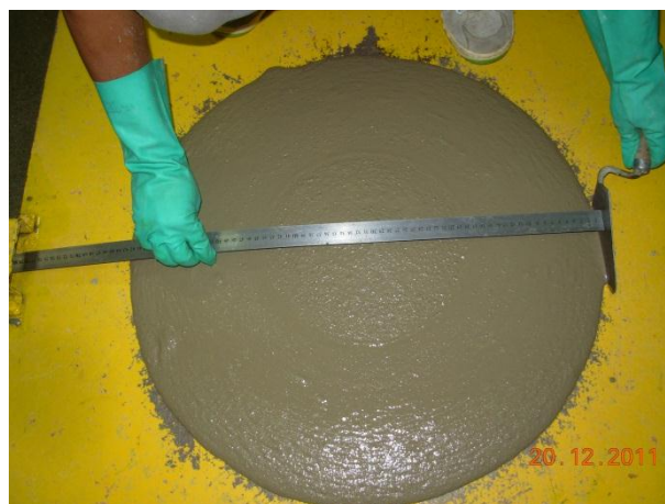
Figura 4.2 - Determinação do espalhamento usando o cone de Abrams.
