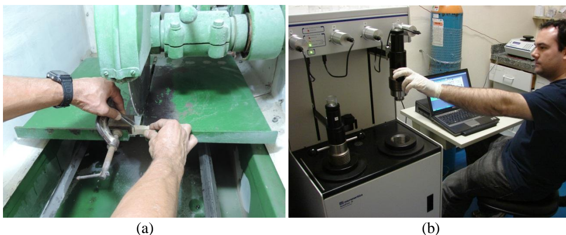
Figura 7.6 – Corte de amostras para ensaios de porosimetria (serra circular) e equipamento AutoPore IV - Micromeritics.
