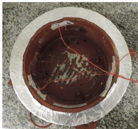
Figura 6.3 – Etapa da desmoldagem para o ensaio de retração restringida: selagem do topo das amostras com fita alumínio.
