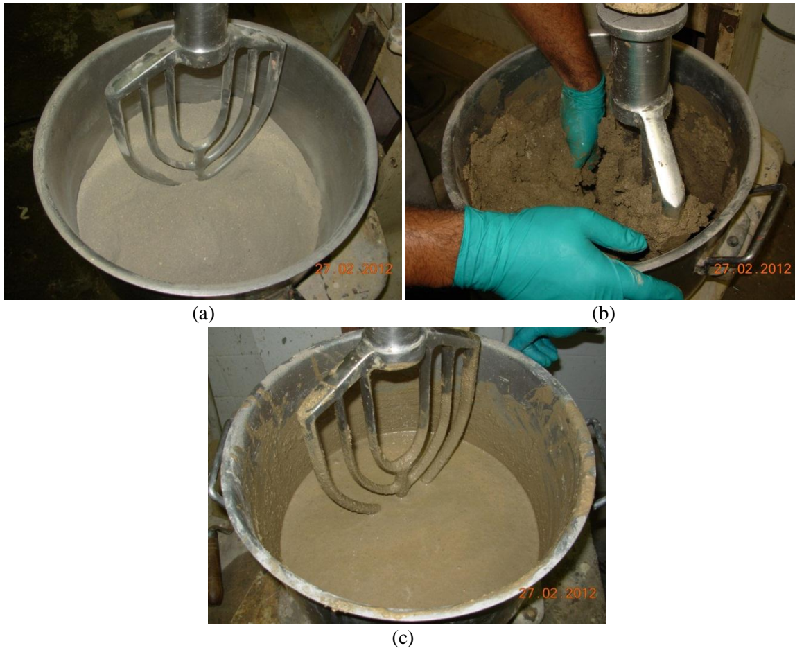
Figura 3.12 - Etapas da produção das misturas (a) homogeneização dos constituintes secos, (b) início da adição de água, revirando-se o fundo e (c) final da mistura.
