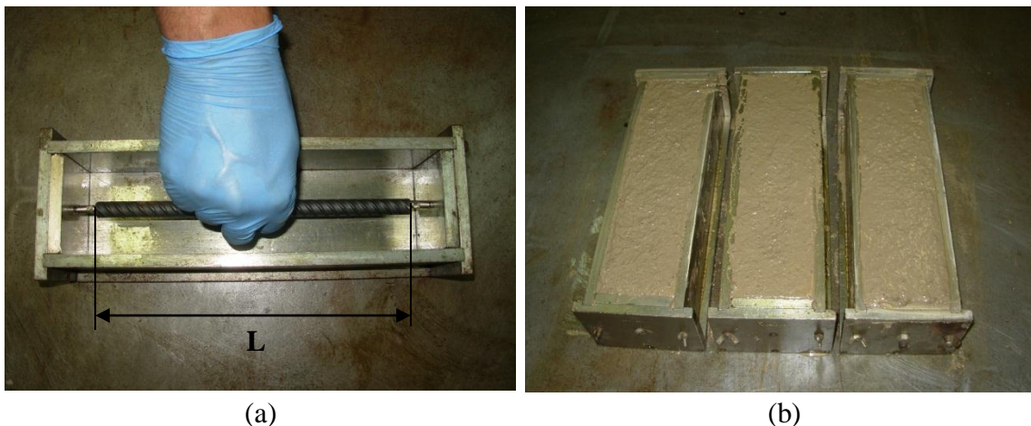
Figura 6.1 - Etapas de moldagem: (a) ajustando a distância entre as extremidades dos pinos (L) e (b) moldagem das misturas com 1,0% de fibras de sisal com 20mm de comprimento.
