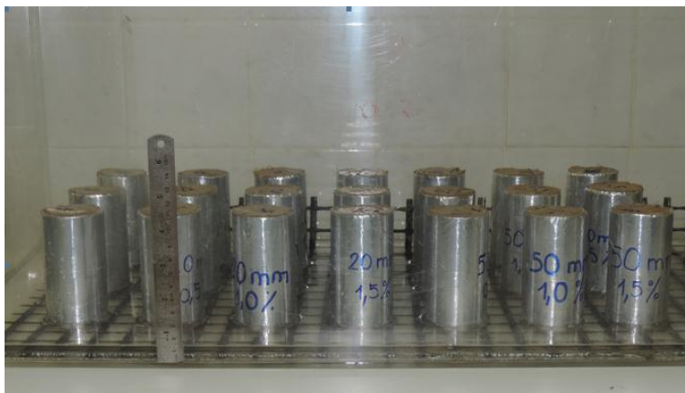
Figura 6.5 – Ensaio de absorção de água por capilaridade.
