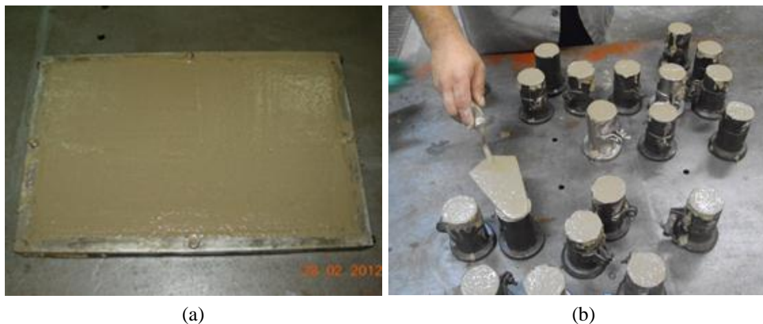
Figura 3.13 - (a) Molde retangular – ensaios de tração, (b) molde cilíndrico – ensaios de compressão.
