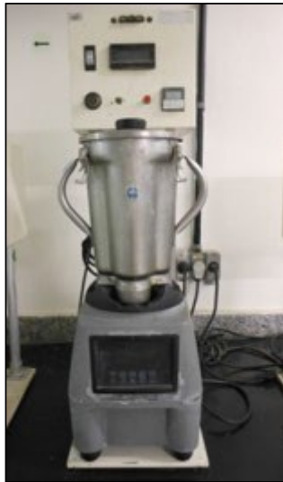
Figura 3.6 – Misturador mecânico Chandler Engineering utilizado para o preparo das misturas.
