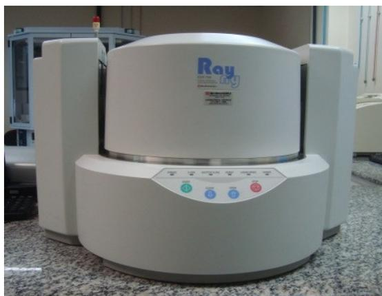
Figura 3.2 - Equipamento utilizado para determinação da composição química.
