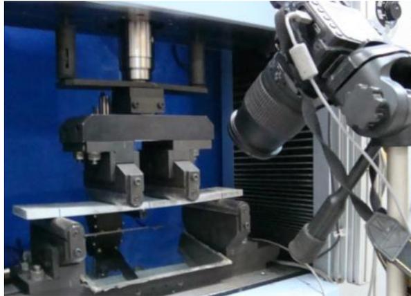
Figura 3.17 - Configuração do ensaio de flexão em quatro pontos e arranjo experimental para análise do patamar de fissuração na flexão.
