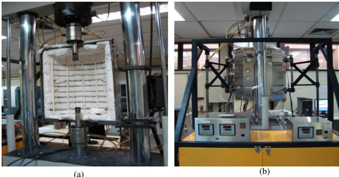
Figura 7.5 – Equipamento para teste de tração (a) vista frontal da prensa Shimadzu com forno aberto acoplado (b) vista lateral da prensa Shimadzu e forno fechado.
