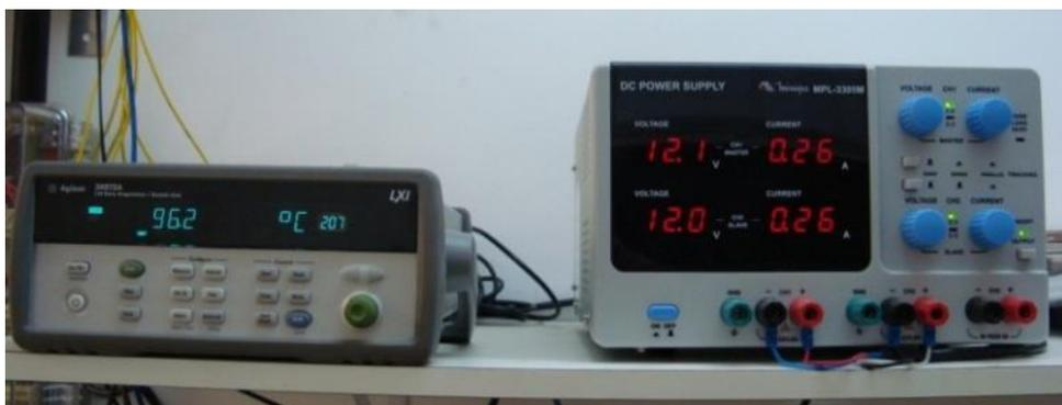
Figura 7.10 – Equipamentos *Datalogger* Agilent e fonte utilizados para aquisição de dados dos LVDT's.
