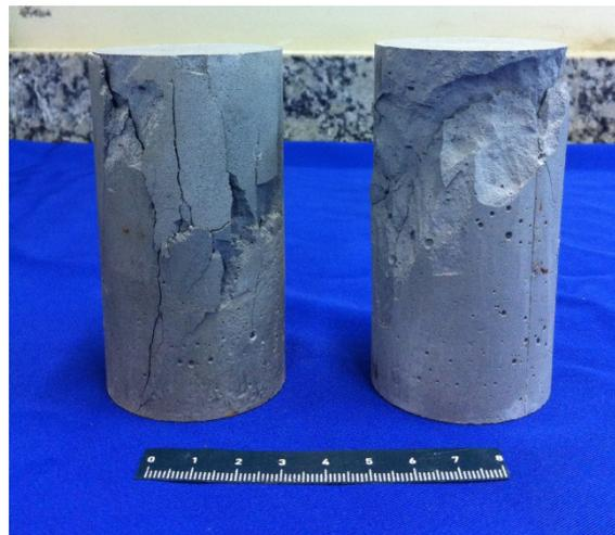
Figura 6.18 – Resultados de resistência à compressão: (a) curvas representativas de testes de resistência à compressão após período de cura na idade de 28 dias de matriz e compósito e (b) matriz na idade de 56 dias nos níveis de umidade de 95% e 0% (c) fratura típica de corpos de prova de matriz na idade de 28 dias e (d) fratura típica de matriz na umidade de 95% (esquerda) e 0% (direita).
