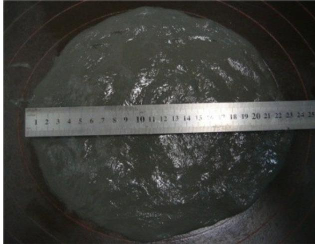
Figura 3.10 - Ensaio de espalhamento do compósito.
