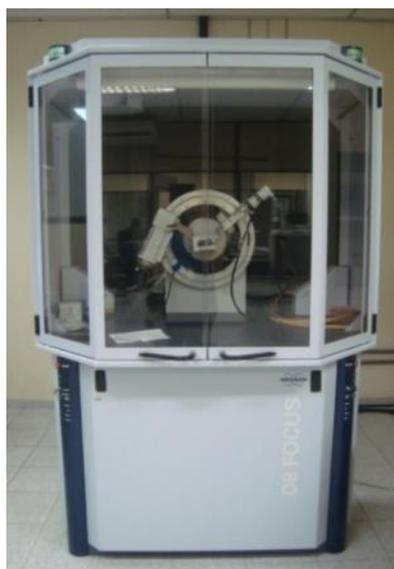
Figura 3.6 - Difratômetro de raios-X utilizado.
