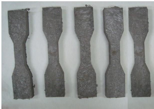
Figura 3.13 - Corpos de prova para o ensaio à tração.
