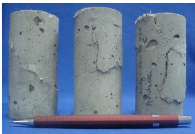
Figura 3.23 – Modo de ruptura típico dos corpos de prova de dimensão 50 mm de diâmetro e 100 mm de comprimento do compósito.
