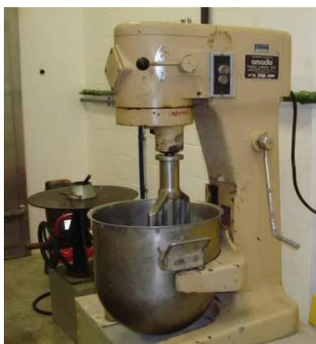
Figura 3.8 - Misturador utilizado para a produção da matriz e do compósito *SHCC*.
