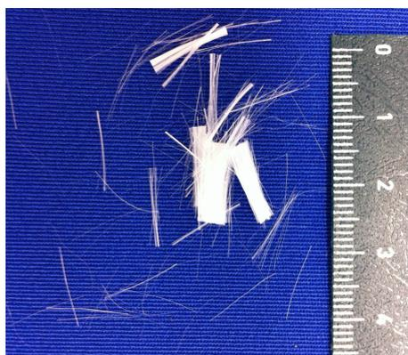
Figura 3.1 - Fibra PVA (REC 15) utilizada com 12 mm de comprimento e 0,040 mm de diâmetro.
