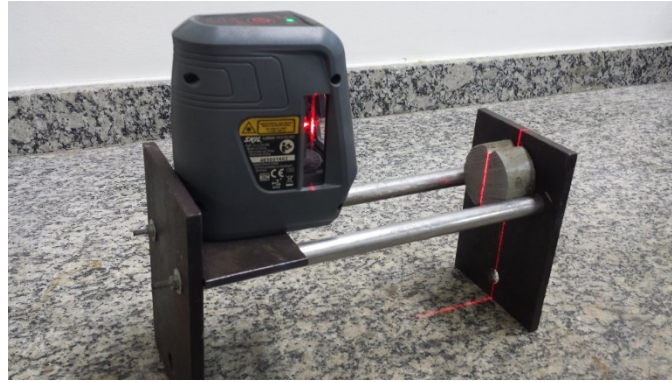
Figura 4.12 – Marcação dos eixos da amostra para fixação do clip gage .
