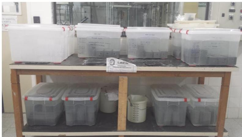
Figura 4.32 – Ensaio de ataque por sulfato nos concretos convencionais e de alto desempenho com 0%, 10% e 15% de CBCA.
