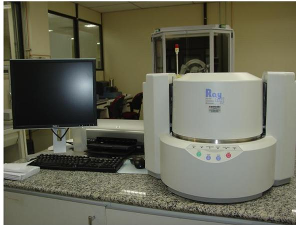
Figura 4.31 – Espectrômetro de fluorescência de raios X – EDX 720.
