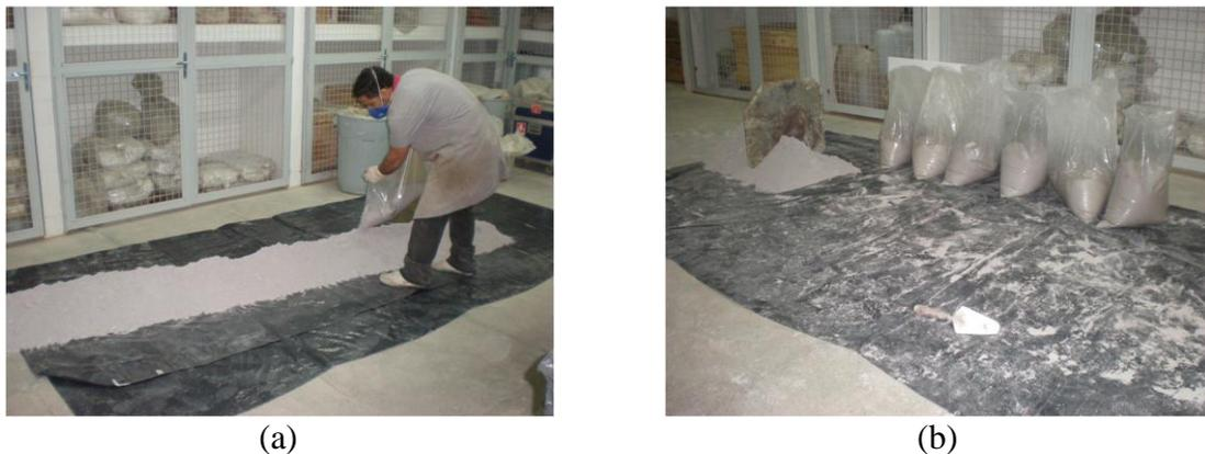
Figura 4.7 – Homogeneização e quarteamento da CBCA: (a) pilha triangular e (b) acondicionamento do material.
