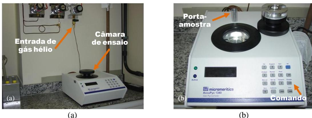
Figura 4.10 – Aparelho de massa específica a gás: (a) vista geral e; (b) vista frontal com câmara de gás aberta e porta amostra utilizado.
