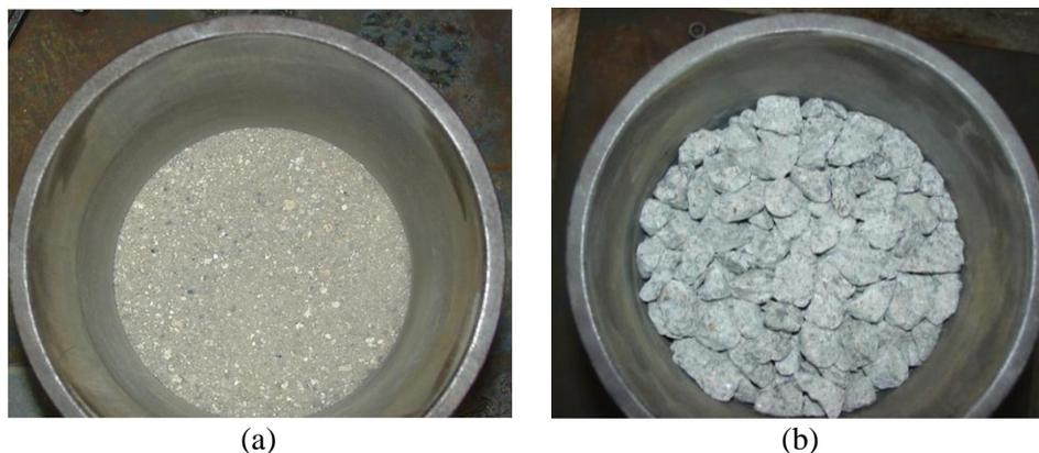
Figura 4.18 – Aspectos das amostras após o ensaio: (a) areia e (b) brita.
