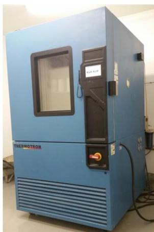
Figura 4.22 – Câmara de carbonatação acelerada.
