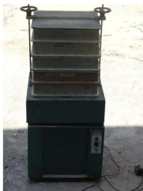
Figura 4.16 – Peneirador elétrico e conjunto de peneiras utilizadas para agregado miúdo e graúdo.
