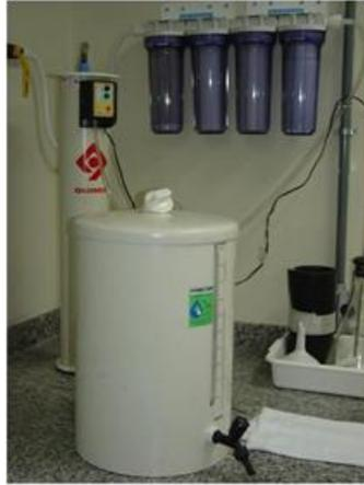
Figura 4.19 – Acondicionamento da água deionizada para confecção de materiais cimentícios.
