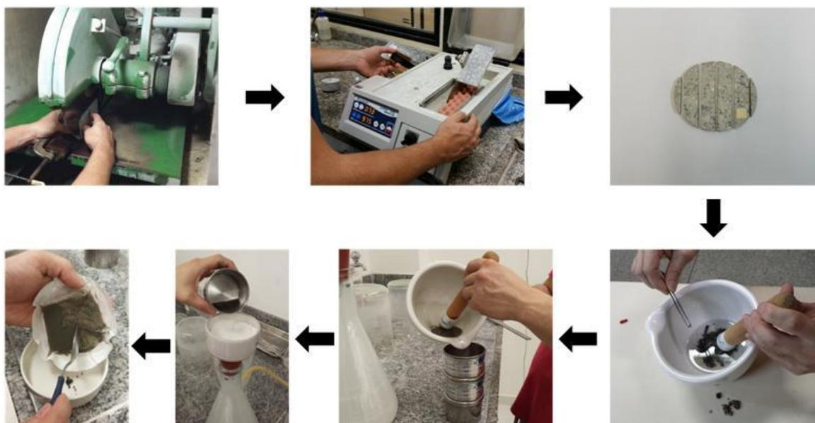
Figura 4.25 – Esquema de preparação das amostras para análise: corte da parede central do corpo de prova, corte das faixas, exemplo de corte no da amostra, moagem das faixas em álcool, peneiramento para retirada de agregados, retirada do excesso de álcool e coleta de material para secagem a vácuo.
