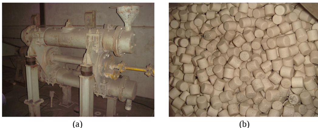
Figura 4.5 – Moinho vibratório (a) e corpos moedores de alumina (b).
