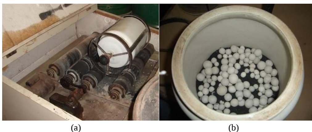
Figura 4.4 – Moinho sobre roletes para início da rotação (a) e cinzas do bagaço da cana-de-açúcar e corpos moedores dentro da carcaça de porcelana (b).
