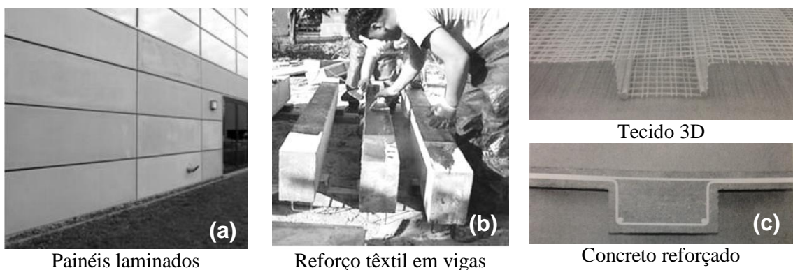
Figura 3.4 – Aplicação de diferentes tipos de têxteis em elementos de concreto.
