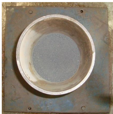
a) Agregado denso depositado no interior do cilindro metálico.
