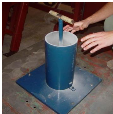
b) Cilindro metálico portando a amostra e o pistão maciço de aço.
