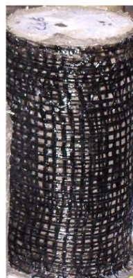
Confinamento de elementos estruturais. Adaptado de: DI LUDOVICO et al. (2010)
