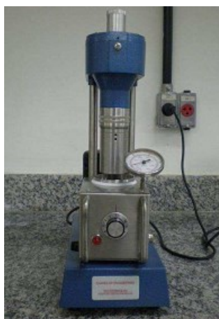
Figura 4.11: Viscosímetro rotativo de cilindros coaxiais com copo térmico, Chandler .
