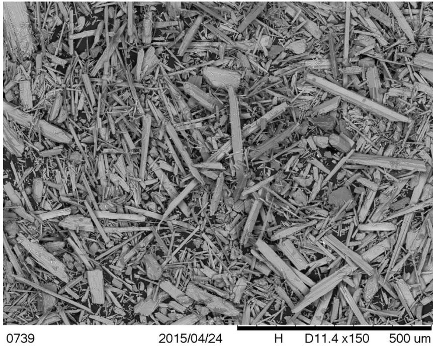
*Figura 22 – Microfibra de wollastonita WO, fornecida por JG Energyarc, observada por microscopia eletrônica de varredura.*
