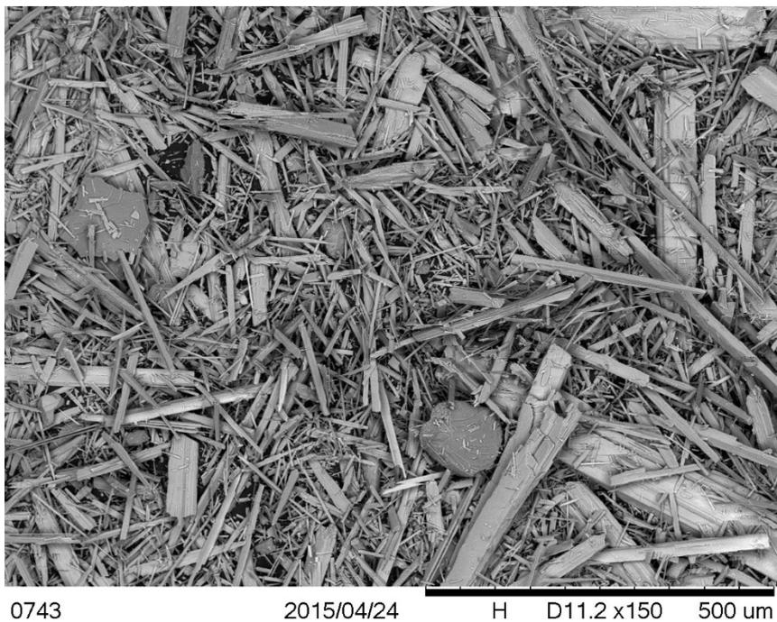
*Figura 23 – Microfibra de wollastonita WN, fornecida por NYCO, observada por microscopia eletrônica de varredura.*
